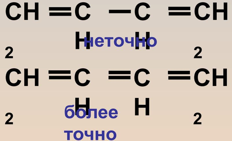
В молекуле бутадиена единая 4-х электронная полностью делокализованная  $\pi$ -связь. Это называется системой сопряжения.
