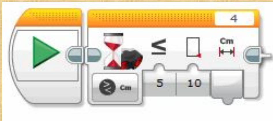
Выберите режим **«Ультразвуковой датчик»** → **«Сравнение»** → **«Расстояние в сантиметрах»**
