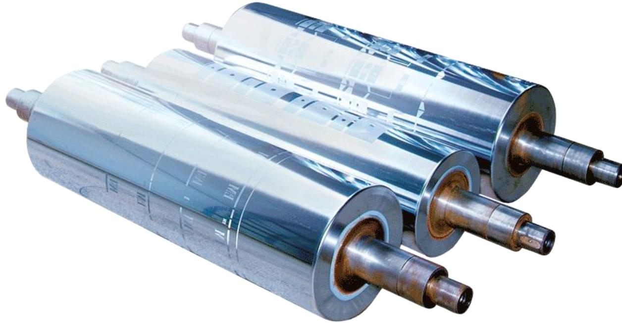
Печатными формами в глубокой печати являются цилиндры. Цилиндры изготавливаются из стали которая сверху покрывается слоем меди и хрома. Медь служит для гравировки цилиндра и сверху покрываются слоем хрома, который защищает цилиндры от повреждений, при контакте с ракелем и запечатываемым материалом.
