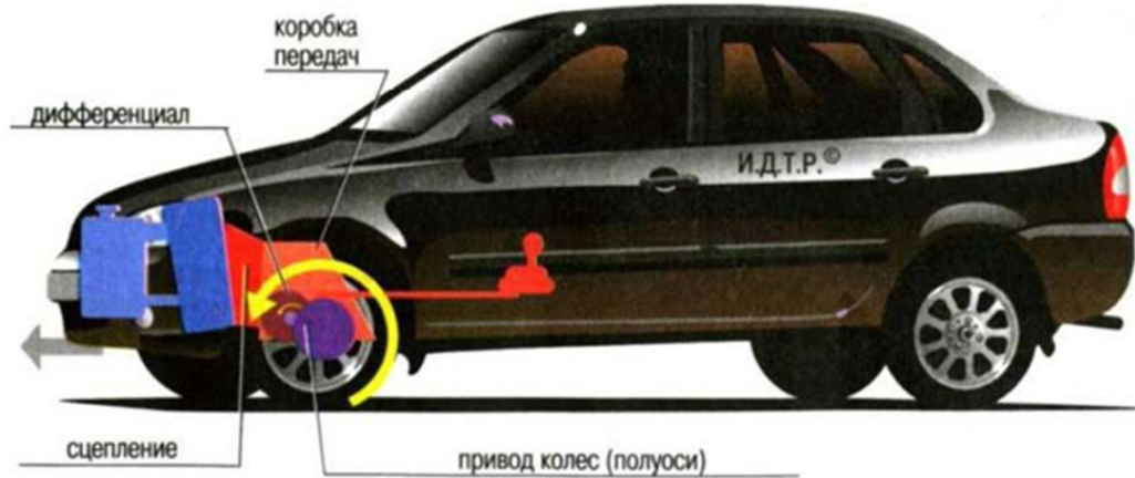
СХЕМА ТРАНСМИССИИ ПЕРЕДНЕПРИВОДНОГО АВТОМОБИЛЯ
