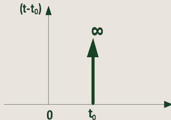
$\delta$ -импульс – сигнал с бесконечно большой амплитудой и бесконечно малой длительностью; площадь его равна 1.
