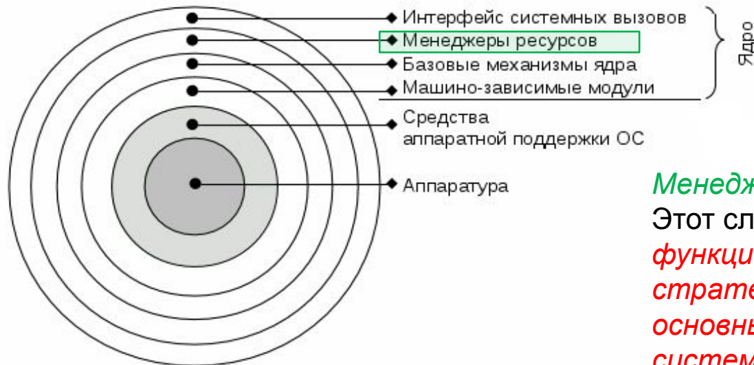
6-слойная структура аппаратной части вычислительной системы и ядра операционной системы
