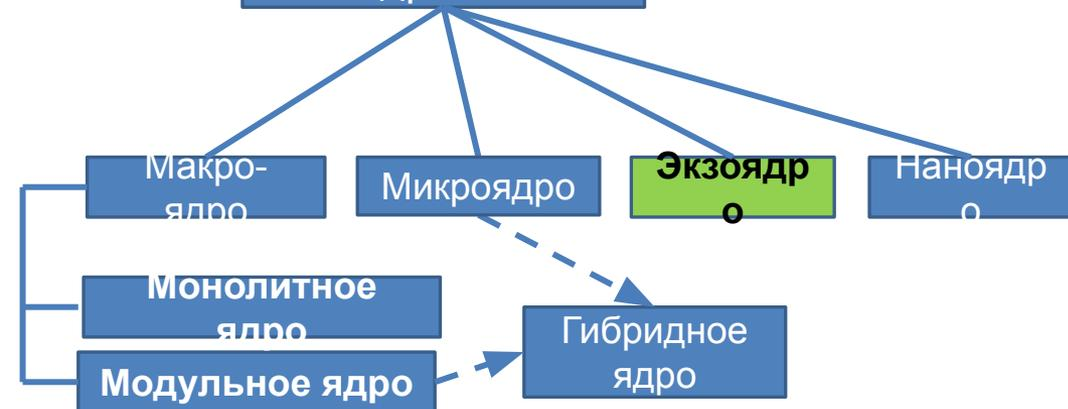
**Экзоядро** - схема, при которой ядро представляет лишь функции для взаимодействия между процессами, безопасного выделения и освобождения ресурсов.
