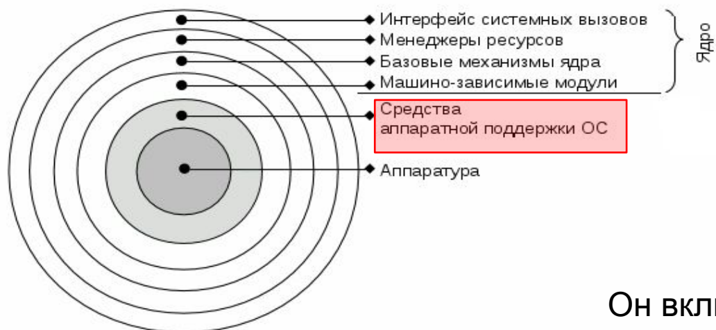
6-слойная структура аппаратной части вычислительной системы и ядра операционной системы
