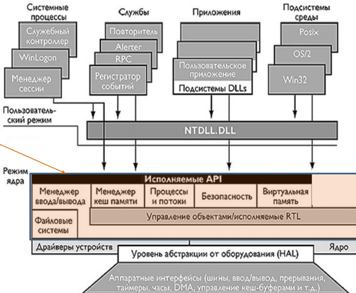
**Режим ядра** - это *привилегированный режим* работы процессора, в котором код получает прямой доступ ко всем аппаратным ресурсам и всей памяти, включая адресные пространства всех процессов режима пользователя.
