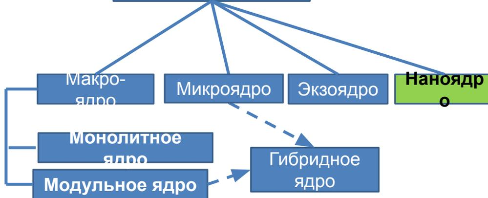
**Наноядро** - схема, при которой крайне упрощённое и минималистичное ядро выполняет лишь одну задачу — **обработку аппаратных прерываний, генерируемых устройствами компьютера.**
