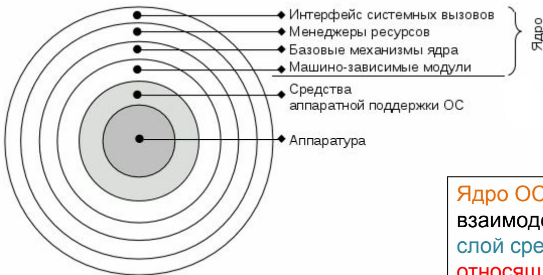
6-слойная структура аппаратной части вычислительной системы и ядра операционной системы
