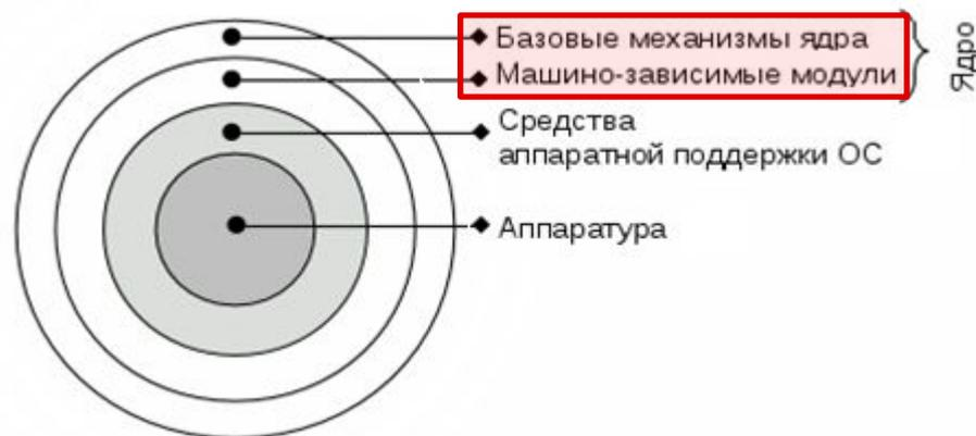
Набор функций микроядра обычно соответствует функциям слоя базовых механизмов обычного ядра.
