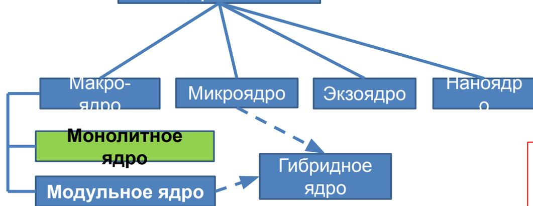
**Монолитное ядро** - схема, при которой все компоненты ядра ОС являются *составными частями одной программы*, используют *общие структуры данных* и взаимодействуют друг с другом путём *непосредственного вызова процедур*.
