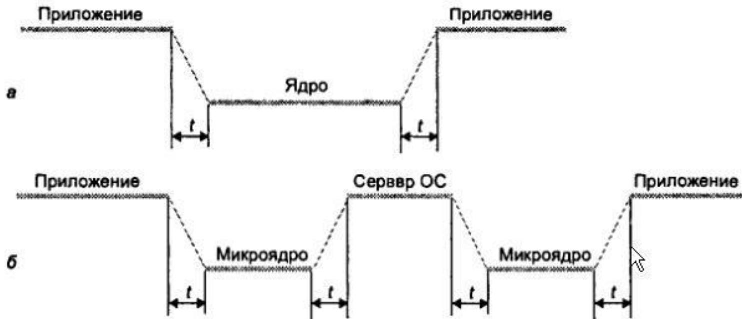
**Производительность.** При классической организации ОС (а) выполнение системного вызова сопровождается **двумя** переключениями режимов, а при микроядерной (б) организации — **четырьмя**.
