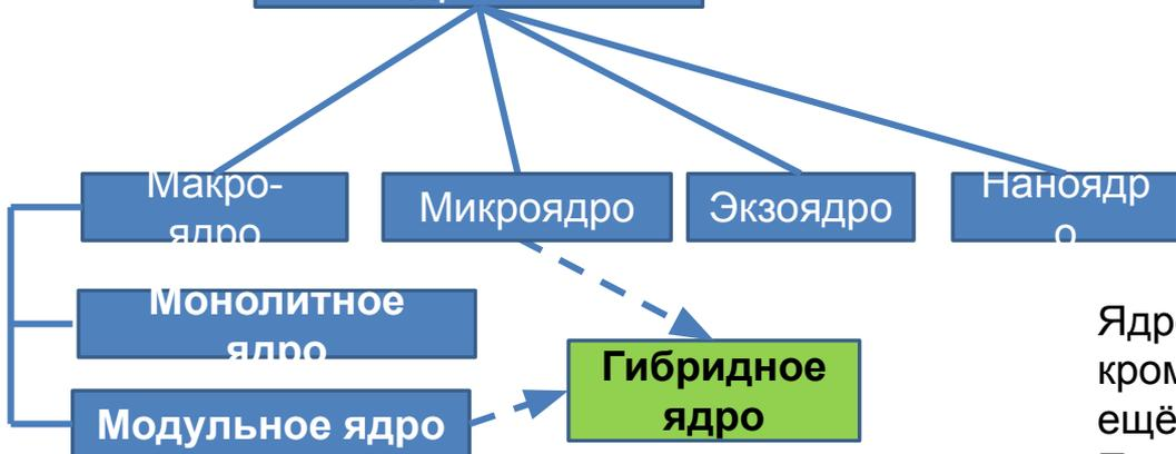
**Гибридные ядра** — это модифицированные микроядра, позволяющие для ускорения работы запускать «несущественные» части в пространстве ядра.
