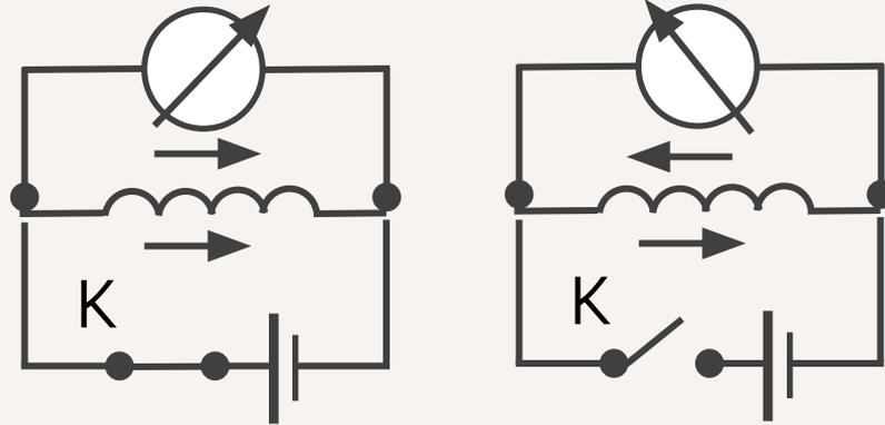
При самоиндукции проводящий контур играет двойную роль: по нему протекает ток, вызывающий индукцию, и в ней же появляется ЭДС индукции.
