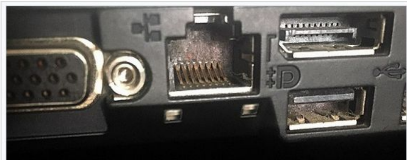
Аппаратные интерфейсы портативного компьютера: сетевой разъем Ethernet (в центре), слева часть порта VGA , справа вверху разъем DisplayPort , справа внизу USB 2.0
