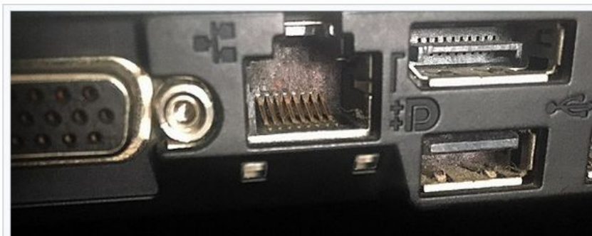
Аппаратные интерфейсы портативного компьютера: сетевой разъем Ethernet (в центре), слева часть порта VGA , справа вверху разъем DisplayPort , справа внизу USB 2.0
