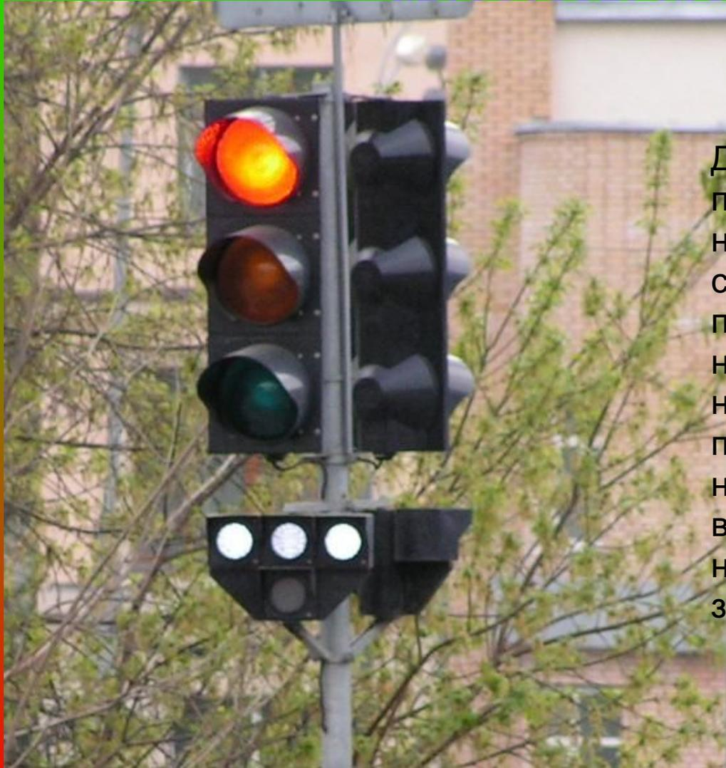
Движение прямо разрешается только при одновременном включении нижнего и верхнего среднего сигналов; поворот направо — только при одновременном включении нижнего и верхнего правого; поворот налево, а также разворот — только при одновременном включении нижнего и верхнего левого. Если включены три верхних сигнала, а нижний выключен, то движение запрещено.
