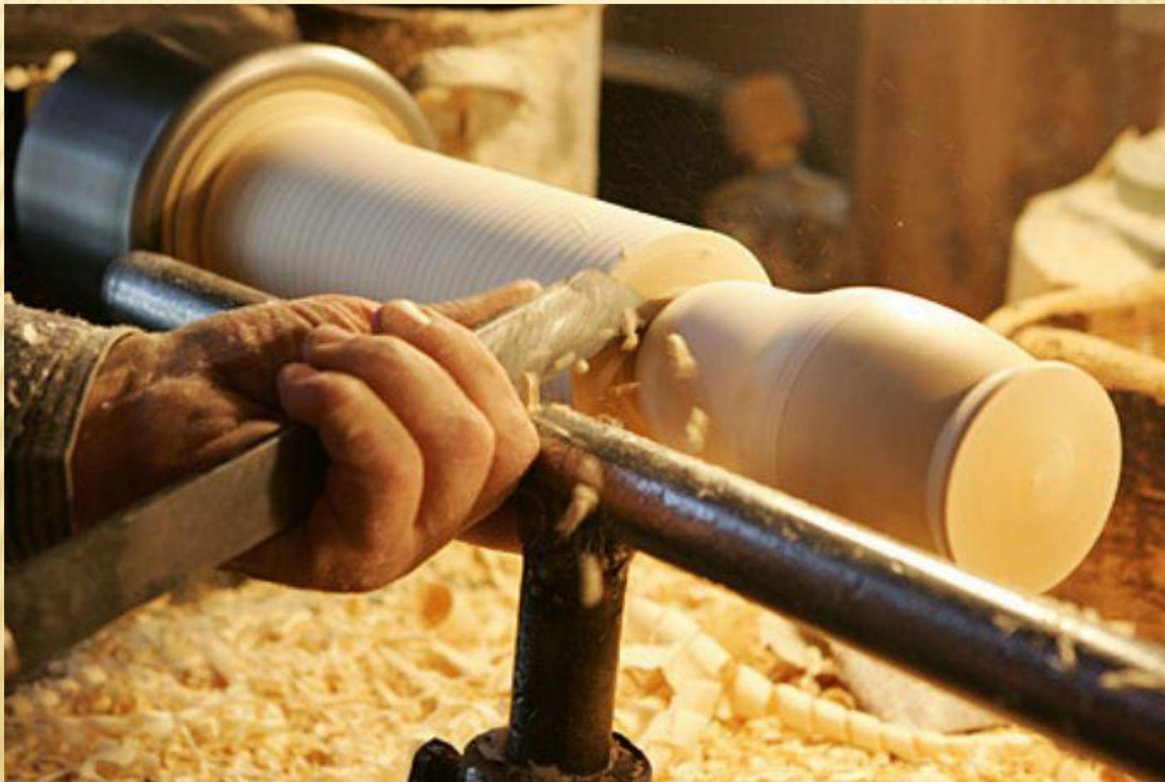
. ДЕРЕВЯННЫЕ ЗАГОТОВКИ МАСТЕР НАЧИНАЕТ ТОЧИТЬ С САМОЙ МАЛЕНЬКОЙ, НЕРАЗЪЕМНОЙ КУКЛЫ. ЗАТЕМ ВЫТАЧИВАЕТ СЛЕДУЮЩУЮ ФИГУРКУ ЧУТЬ БОЛЬШЕГО РАЗМЕРА, УЖЕ СКЛАДНУЮ, И ТАК ДАЛЕЕ, ДО САМОЙ БОЛЬШОЙ.
