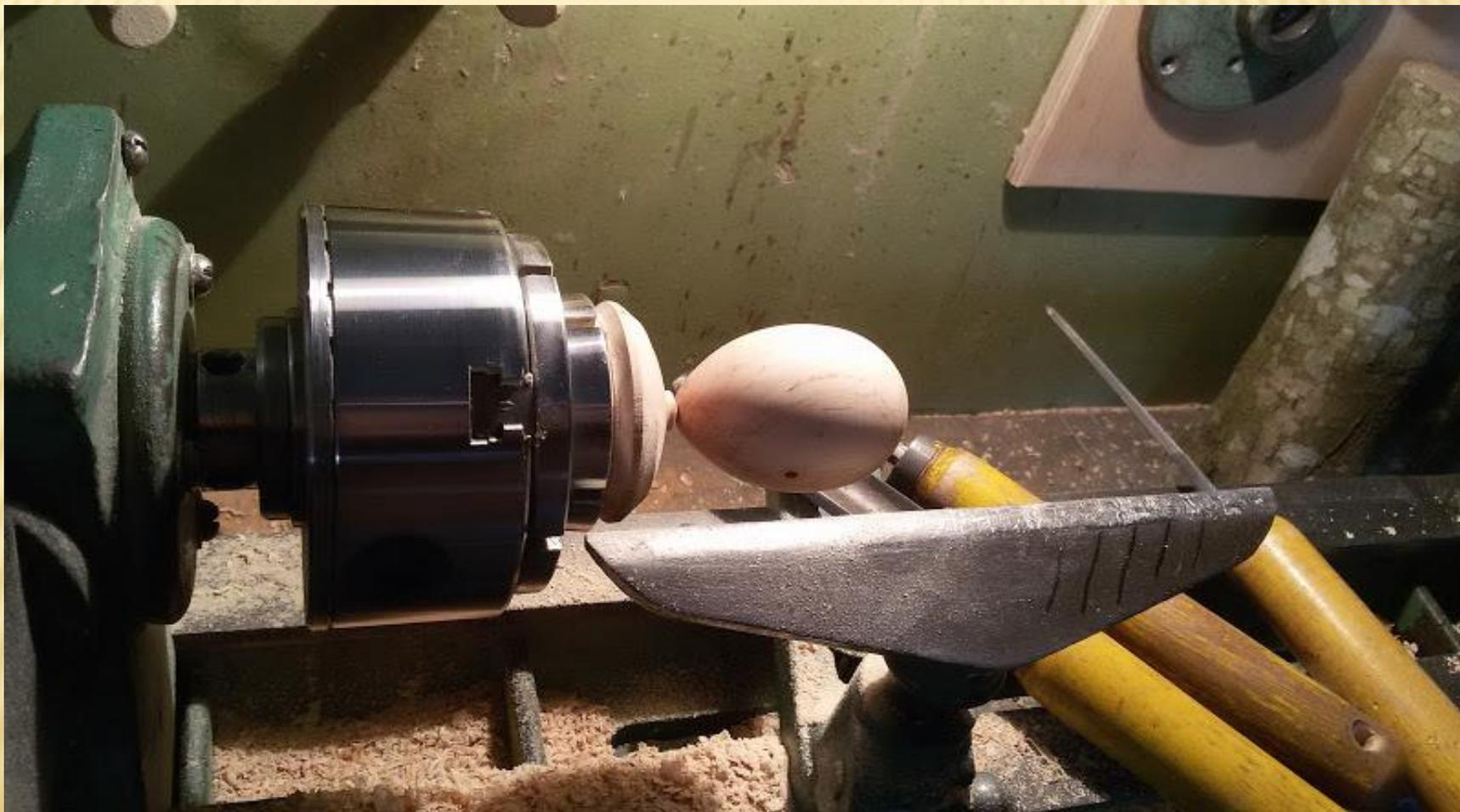
ПОСЛЕ ТОГО, КАК ЗАГОТОВКА ГОТОВА, МАСТЕР РАЗРЕЗАЕТ ЕЕ НА ДВЕ ЧАСТИ – ВЕРХНЮЮ И НИЖНЮЮ. ПЕРВОЙ ВЫТАЧИВАЕТСЯ НИЖНЯЯ ЧАСТЬ, ЗАТЕМ ВЕРХНЯЯ. НЕОБХОДИМО УДАЛИТЬ ДРЕВЕСИНУ ИЗ ОБЕИХ ЧАСТЕЙ ТАК, ЧТОБЫ МЕНЬШАЯ ФИГУРКА ПЛОТНО ВХОДИЛА ВНУТРЬ ПОСЛЕДУЮЩЕЙ ФИГУРКИ.
