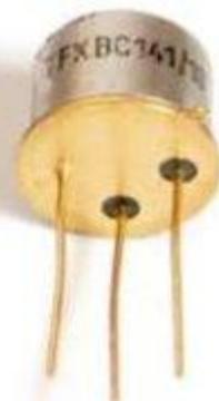
**Транзистор** — радиоэлектронный компонент из полупроводникового материала, обычно с тремя выводами, позволяющий входным сигналам управлять током в электрической цепи.
