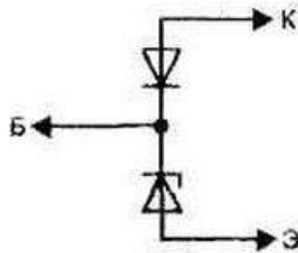
схематическое изображение биполярного транзистора:
