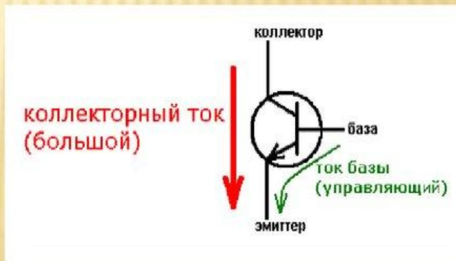
Поскольку переход ЭБ открыт, то электроны легко «перебегают» в базу. Там они частично рекомбинируют с дырками, но большая их часть из-за малой толщины базы и ее слабой легированности успевает добежать до перехода база-коллектор. Который, как мы помним, включен с обратным смещением. А поскольку в базе электроны — неосновные носители заряда, то электрическое поле перехода помогает им преодолеть его. Таким образом, ток коллектора получается лишь немного меньше тока эмиттера.
