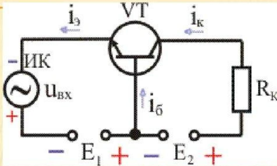
Эта схема не дает значительного усиления сигнала, зато хороша на высоких частотах, поскольку позволяет более полно использовать частотную характеристику транзистора. Если один и тот же транзистор включить сначала по схеме с общим эмиттером, а потом с общей базой то во втором случае будет наблюдаться значительное увеличение его граничной частоты усиления.
