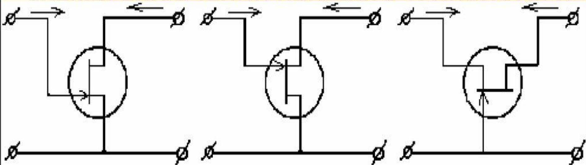
Полевой транзистор в качестве элемента схемы представляет собой **активный несимметричный четырехполюсник**, у которого один из зажимов является общим для цепей входа и выхода. В зависимости от того, какой из электродов полевого транзистора подключен к общему выводу, различают схемы: **с общим истоком и входом на затвор**; **с общим стоком и входом на затвор**; **с общим затвором и входом на исток**. Схемы включения полевого транзистора показаны на рис. 6.
