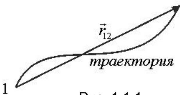
Отрезок прямой, проведенный из начального положения частицы в конечном, называется перемещением. На рис. 1.1.1 вектор перемещения  $\vec{r}_{12}$
