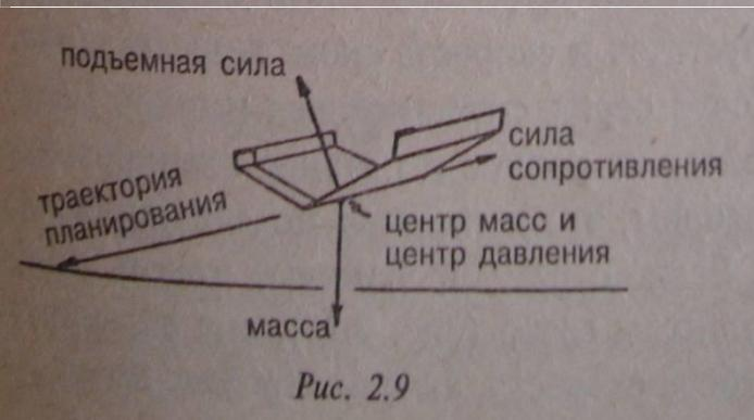
Решающее значение имеет способ запуска планера. Сбалансированная и отрегулированная модель, запущенная с достаточной скоростью, красиво спланирует по прямой, без пикирования и разворотов вправо или влево.
