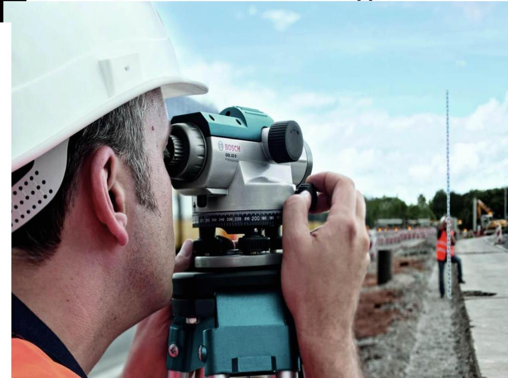
При небольших размерах площадки нивелирование вершин квадратов может выполняться с одной станции. Отметку от репера на одну из вершин квадратов, например, на 2г, передают нивелированием из середины.
