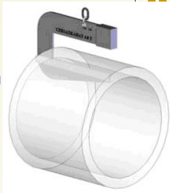
Траверса-захват для монтажа цилиндрических звеньев тоннеля
