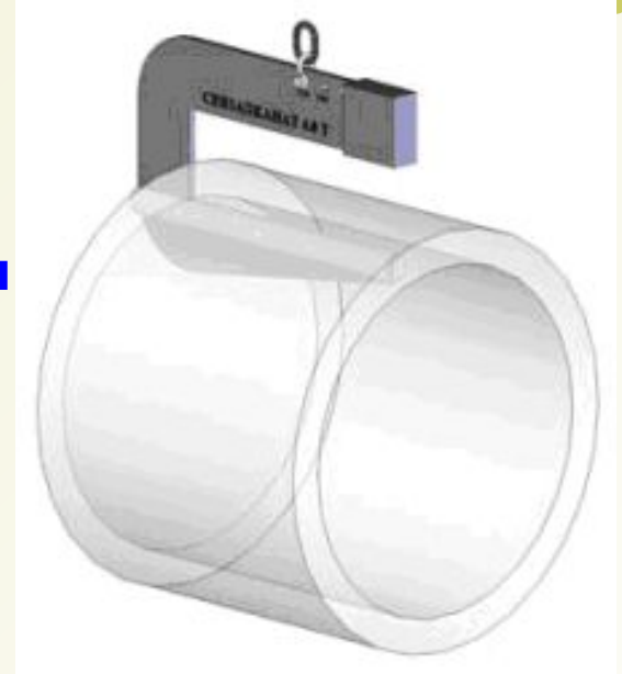
Траверса-захват для монтажа цилиндрических звеньев тоннеля
