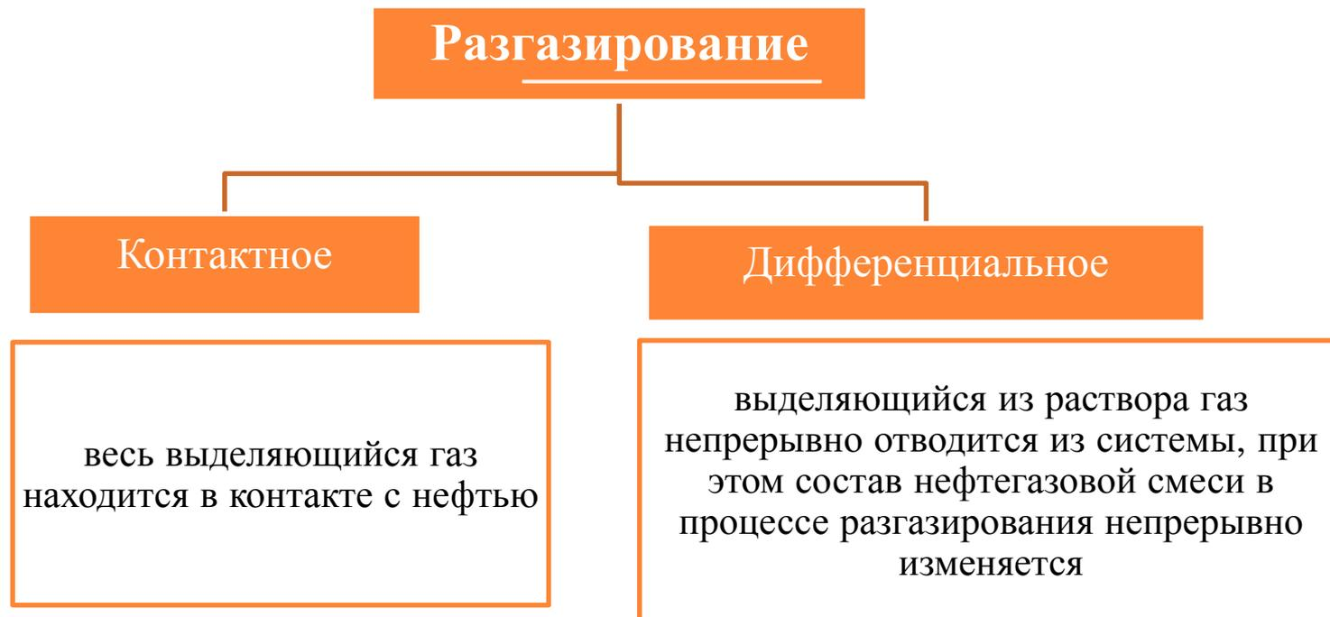
*Коэффициентом разгазирования* принято называть количество газа, выделяющегося из единицы объема нефти при снижении давления на единицу.
