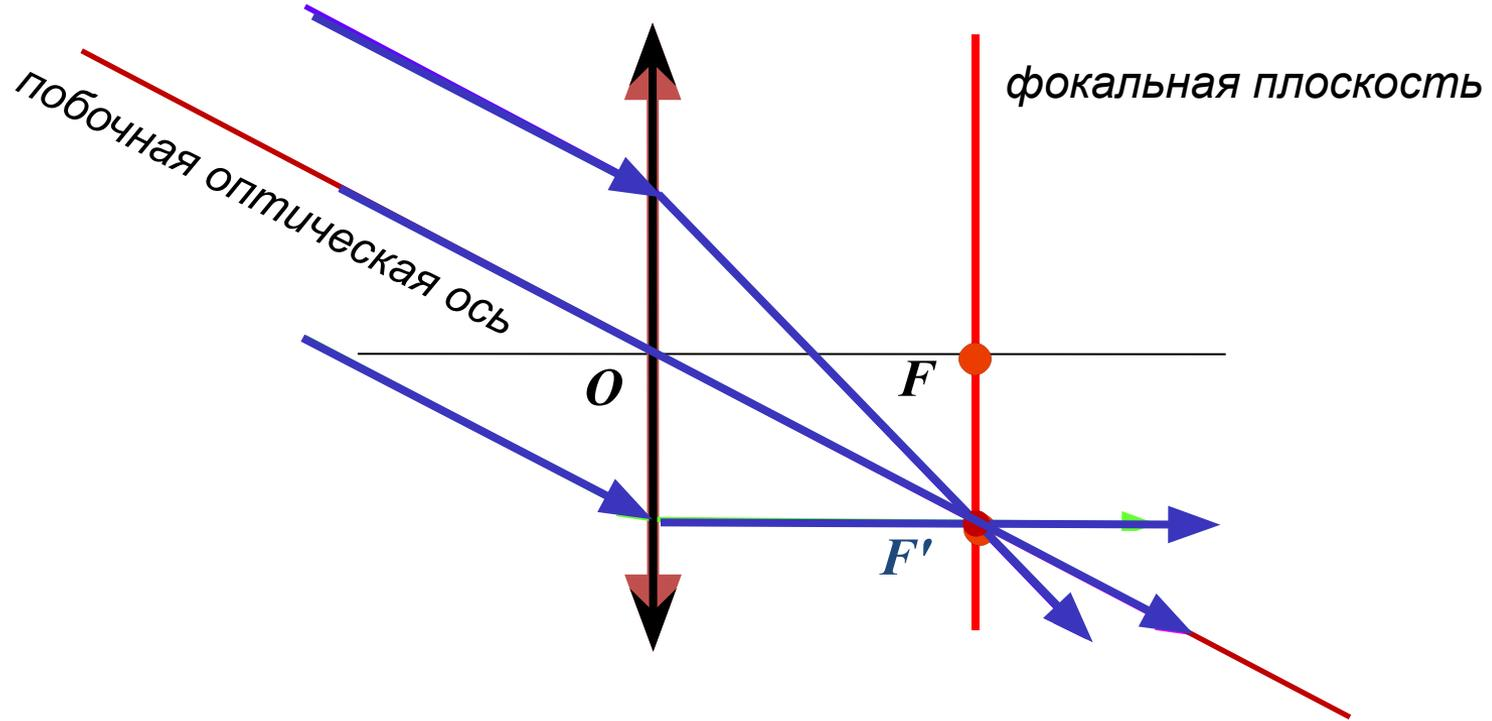
В **побочном фокусе** сходятся все лучи, падающие на линзу **параллельно побочной** оптической оси.
