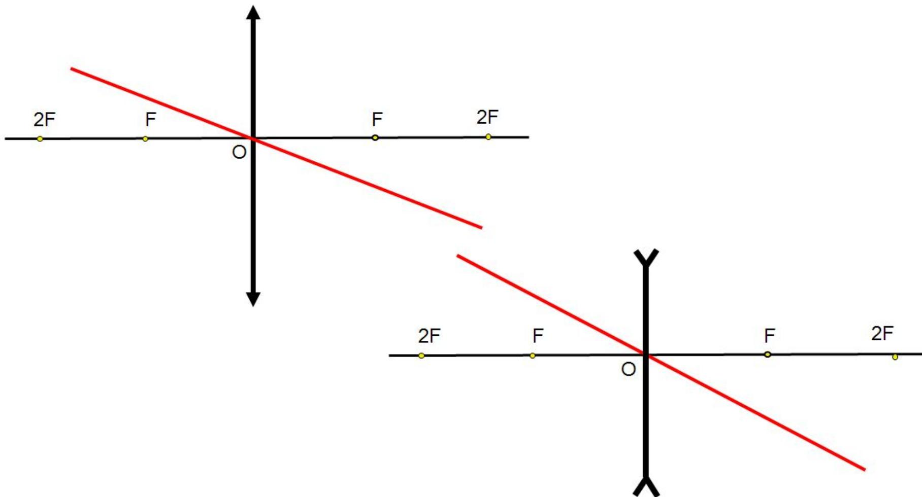
Прямая, проходящая через оптический центр линзы не совпадающая с главной оптической осью называется ***побочной оптической осью***.
