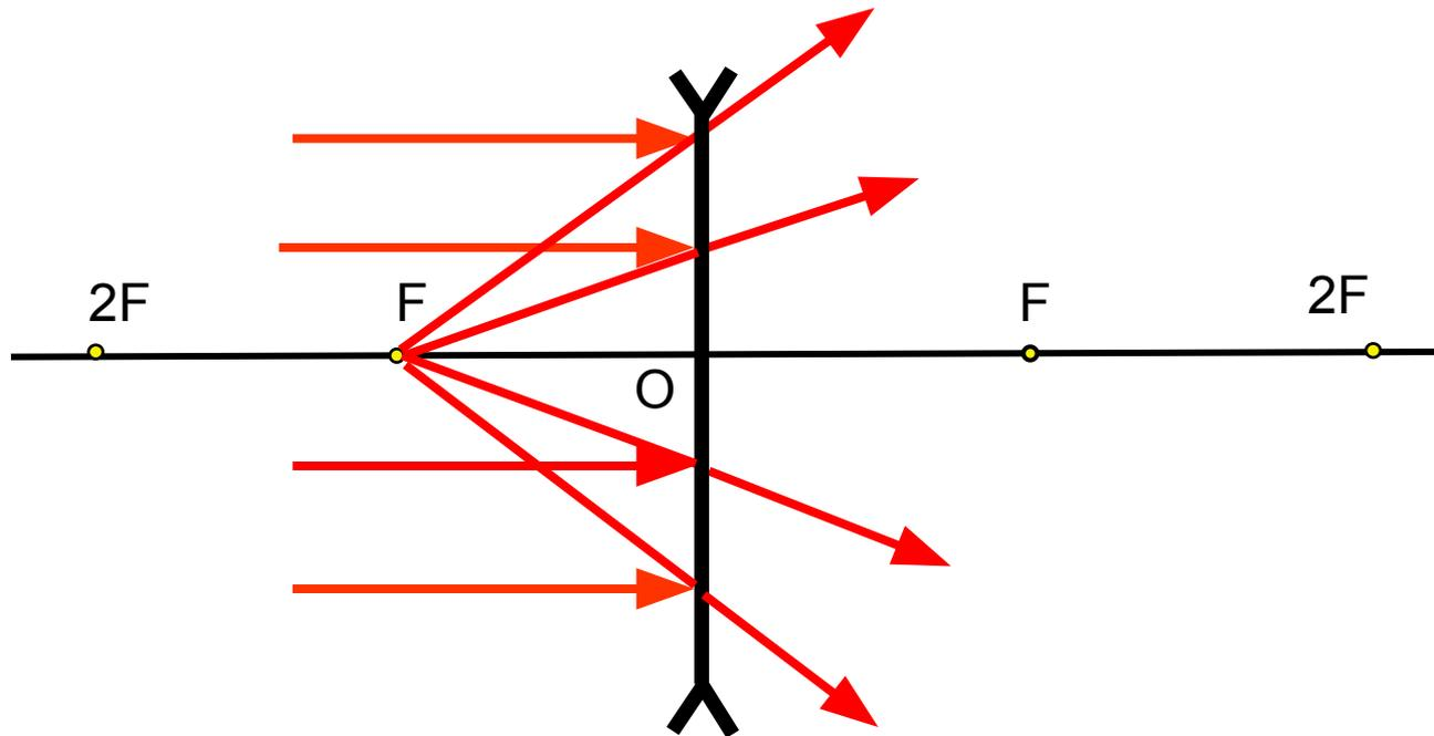
В **главном фокусе рассеивающей** линзы пересекаются **продолжения лучей**, которые до преломления были параллельны главной оптической оси.
