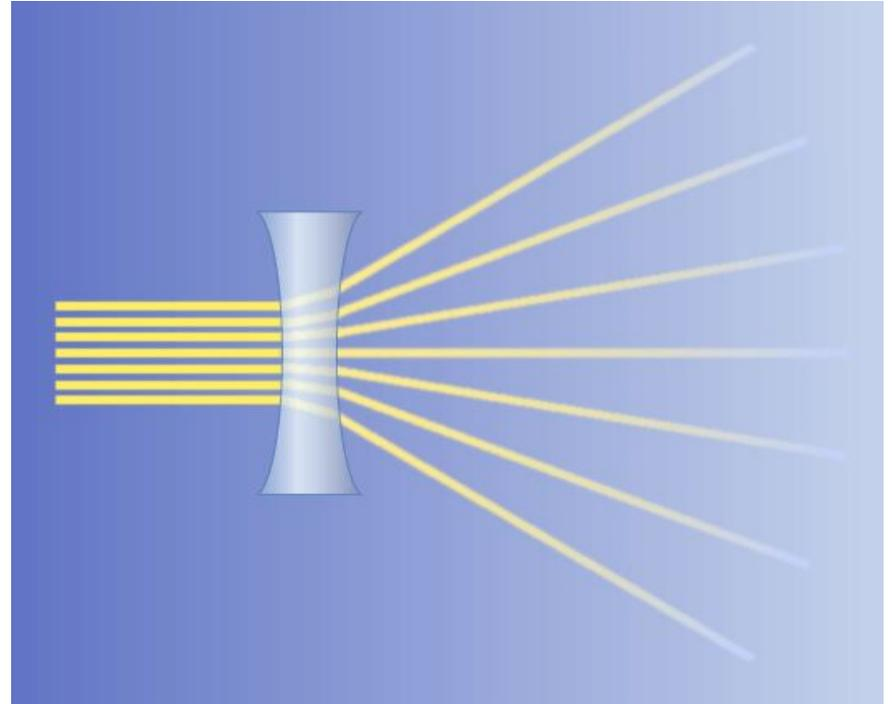
**Линзы**, которые преобразуют пучок **параллельных** лучей в **расходящийся** называют **рассеивающими** линзами.
