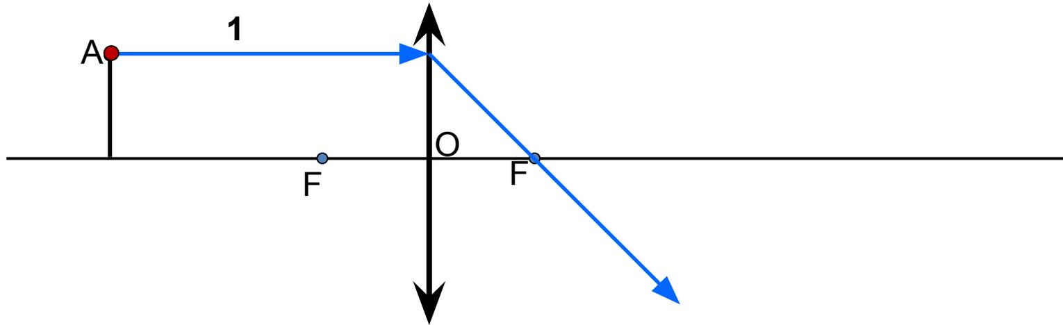
1 – Луч, падающий **параллельно главной оптической оси** линзы после преломления проходит **через первый фокус**.
