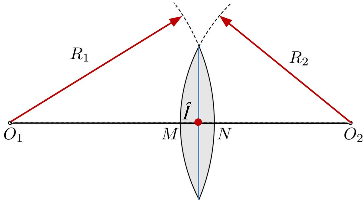
**Главная оптическая ось** линзы – это прямая, проходящая через центры  $O_1 O_2$  сферических поверхностей, ограничивающих линзу
