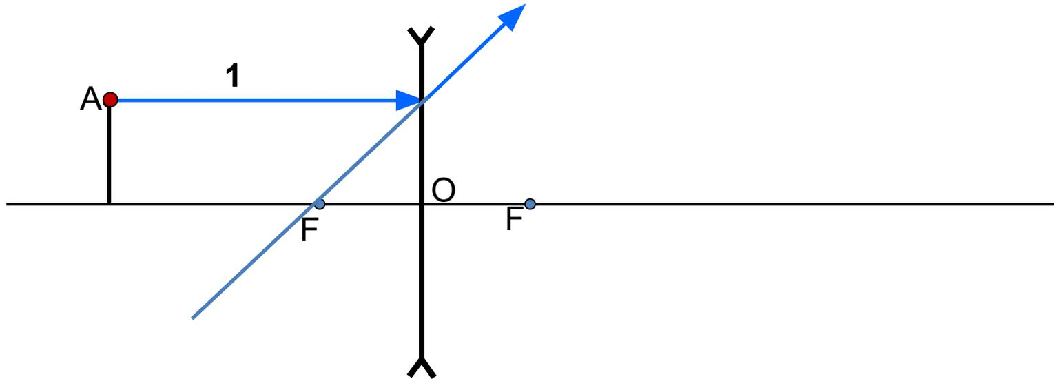
**1** – Луч падает *параллельно главной оптической оси*.
