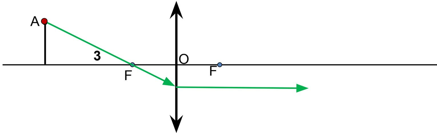
**3** – Падающий луч, проходящий через фокус, после преломления проходит **параллельно главной оптической оси** .
