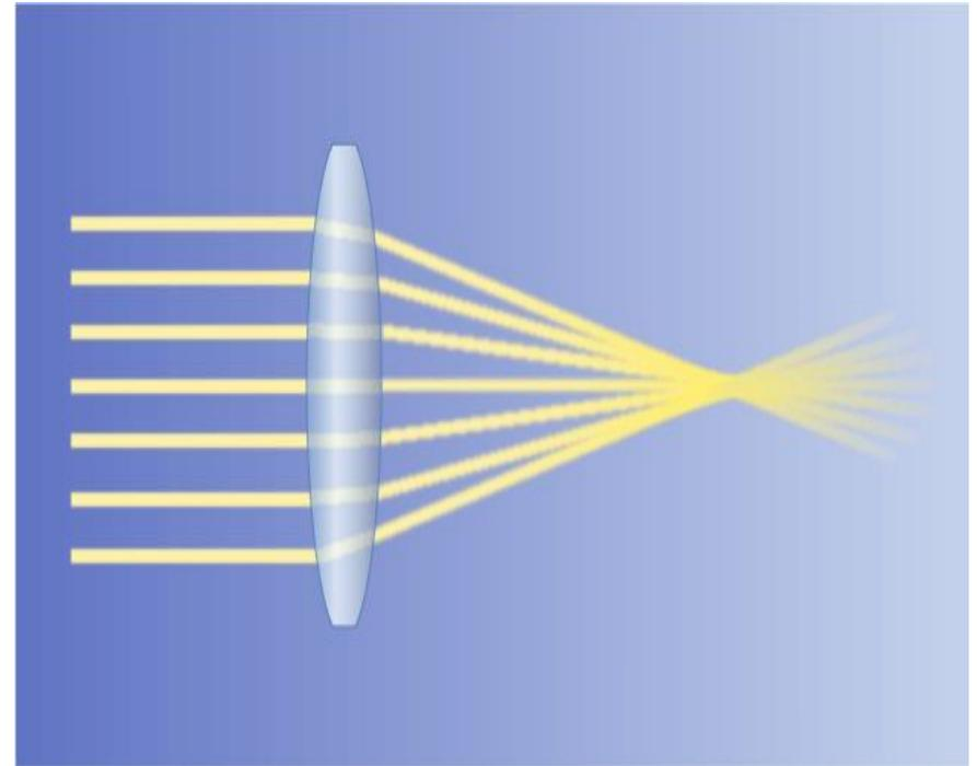
**Линзы**, которые преобразуют пучок **параллельных** лучей в **сходящийся** и собирают его в одну **точку** называют **собирающими** линзами.
