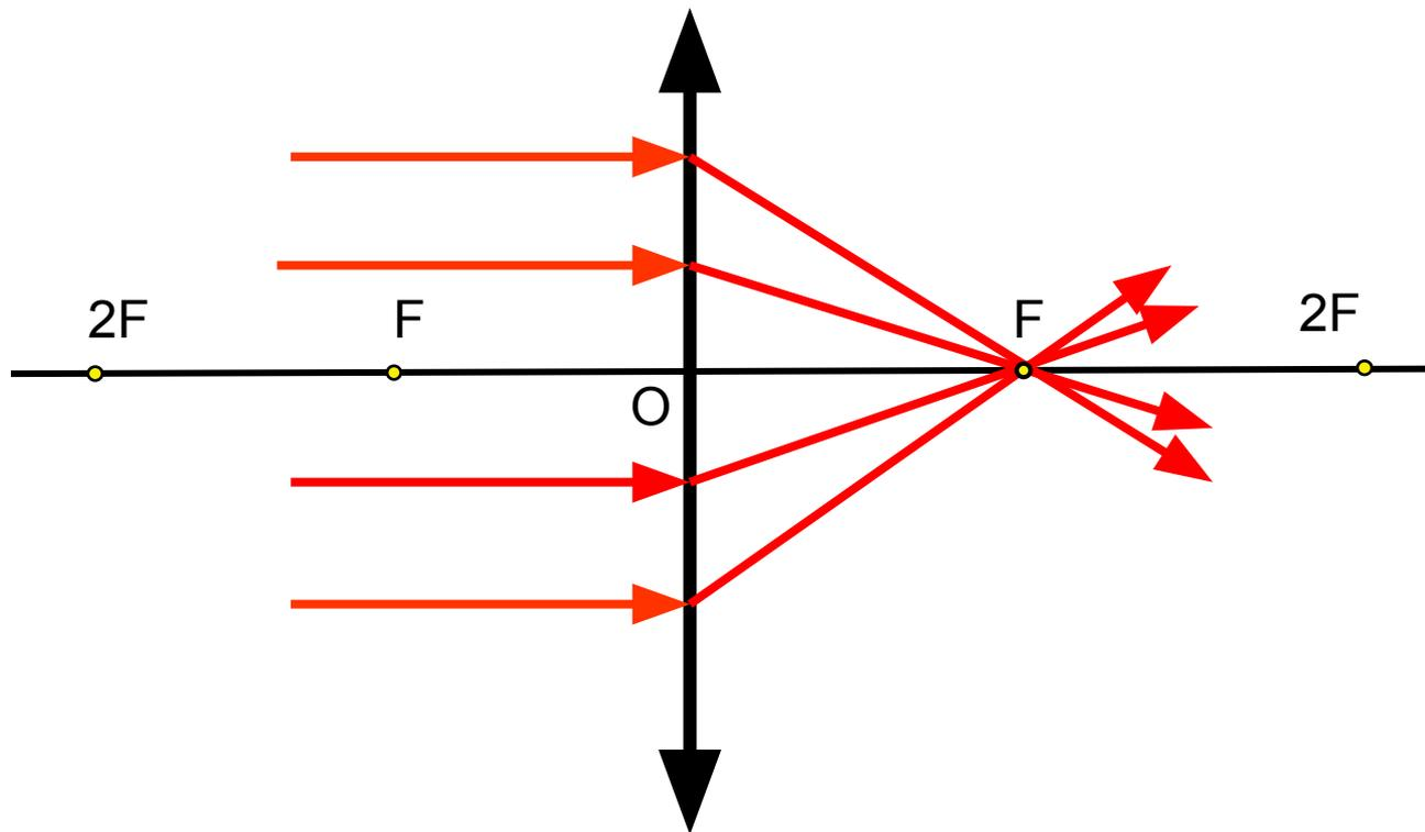
**Главный фокус** собирающей линзы **F** – точка на главной оптической оси, в которой лучи, падающие **параллельно** главной оптической оси **собираются** после их преломления в линзе.
