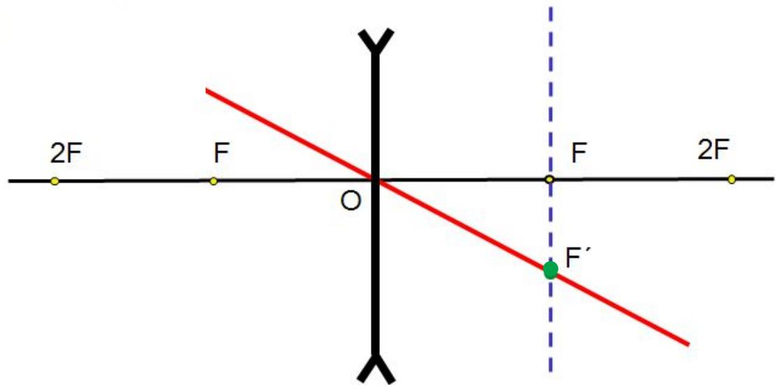
Точка пересечения побочной оптической оси с фокальной плоскостью называется **побочным фокусом** (**F'**)
