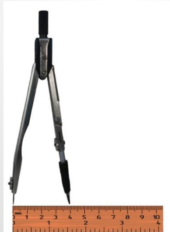
Отмеривание радиуса окружности по линейке
