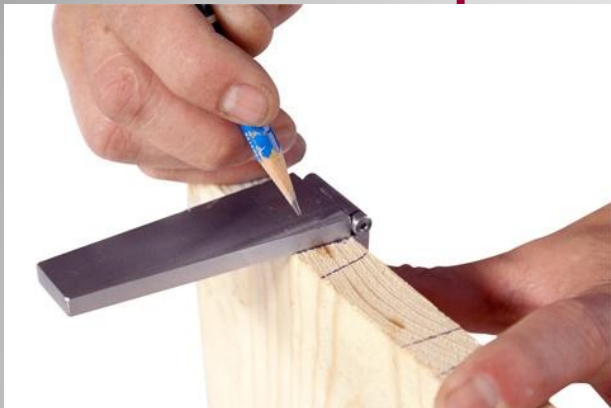
Шаблон для разметки под ласточкин хвост
