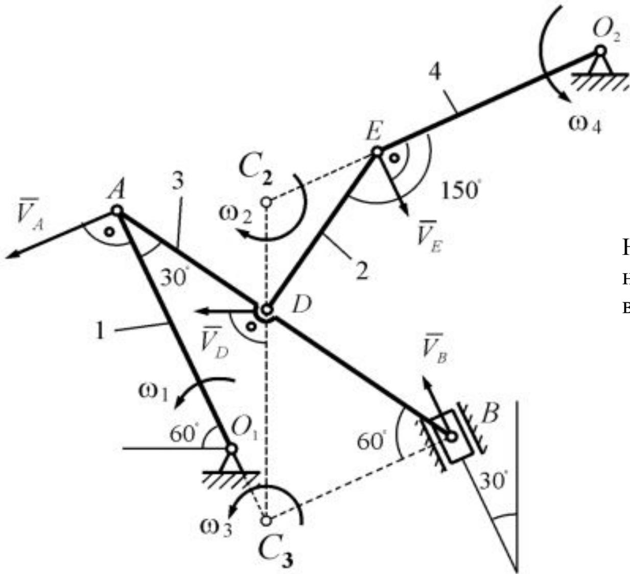
Определяем угловую скорость стержня  $EO_2$
