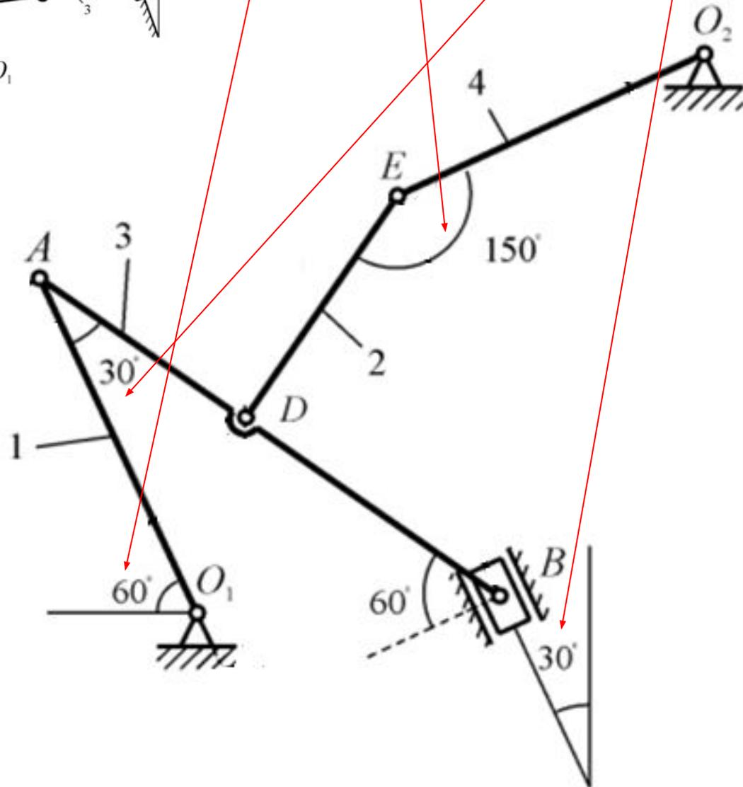
Строим положение механизма в соответствии с заданными углами
