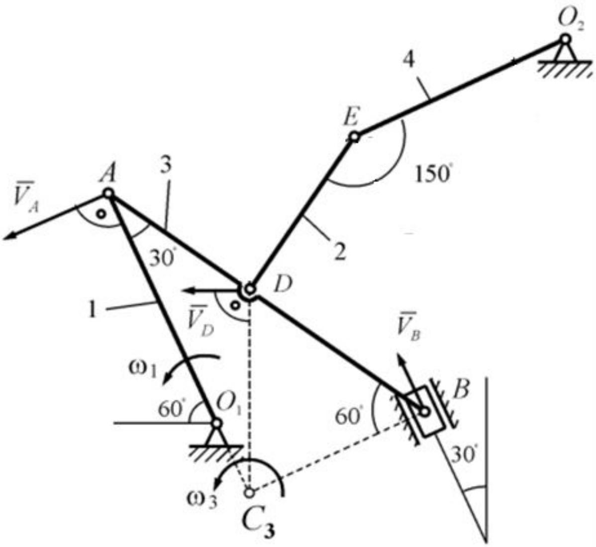
Определяем скорость точки  $D$ , принадлежащей стержню 3
