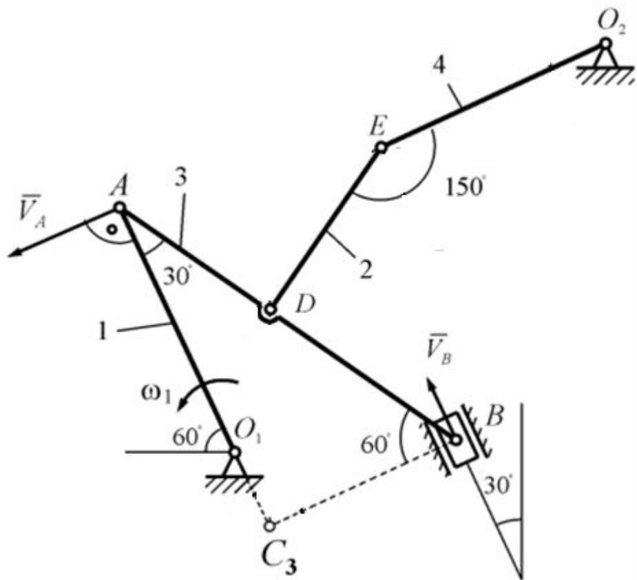
Определяем скорость точки  $B$ . Точка  $B$  принадлежит стержню  $AB$ , который совершает плоскопараллельное движение. Чтобы найти  $\vec{V}_B$  надо знать скорость какой-нибудь другой точки этого стержня, нам известна скорость точки  $A$ ) и направление  $V_B$
