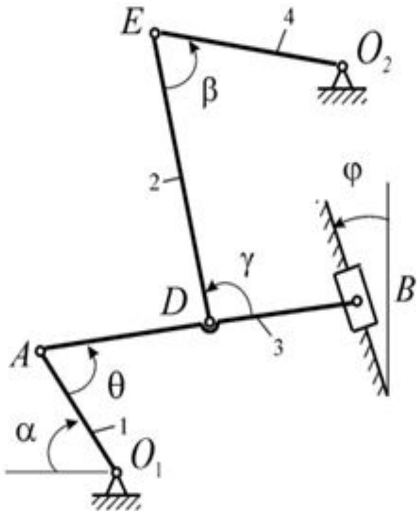
Плоский механизм состоит из стержней 1, 2, 3 и 4 и ползуна В, соединенных друг с другом и с неподвижными опорами  $O_1$  и  $O_2$  шарнирами.
