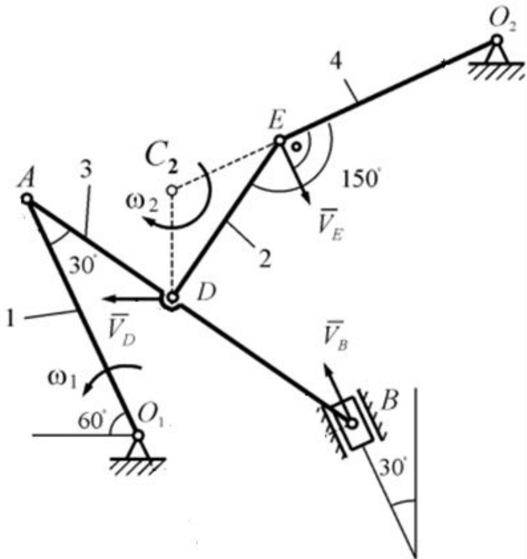
По направлению найденного ранее вектора  $\vec{V}_D$  определяем направление поворота стержня DE вокруг центра  $C_2$ . Вектор  $\vec{V}_E$  направлен соответственно повороту этого стержня.
