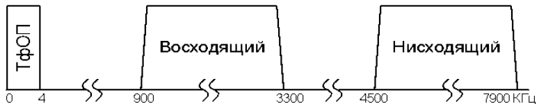
Р и с. 7. Распределение частотного спектра при использовании xDSL
