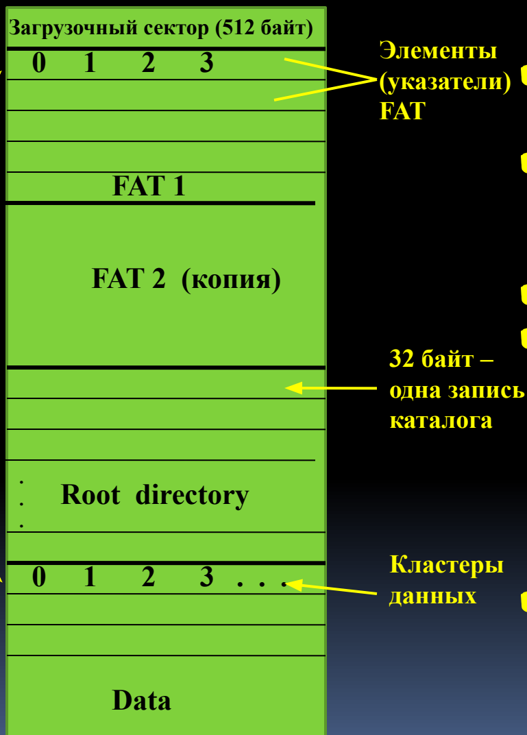
Физическая структура файловой системы FAT
