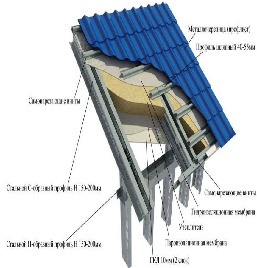
Пример устройства кровли
