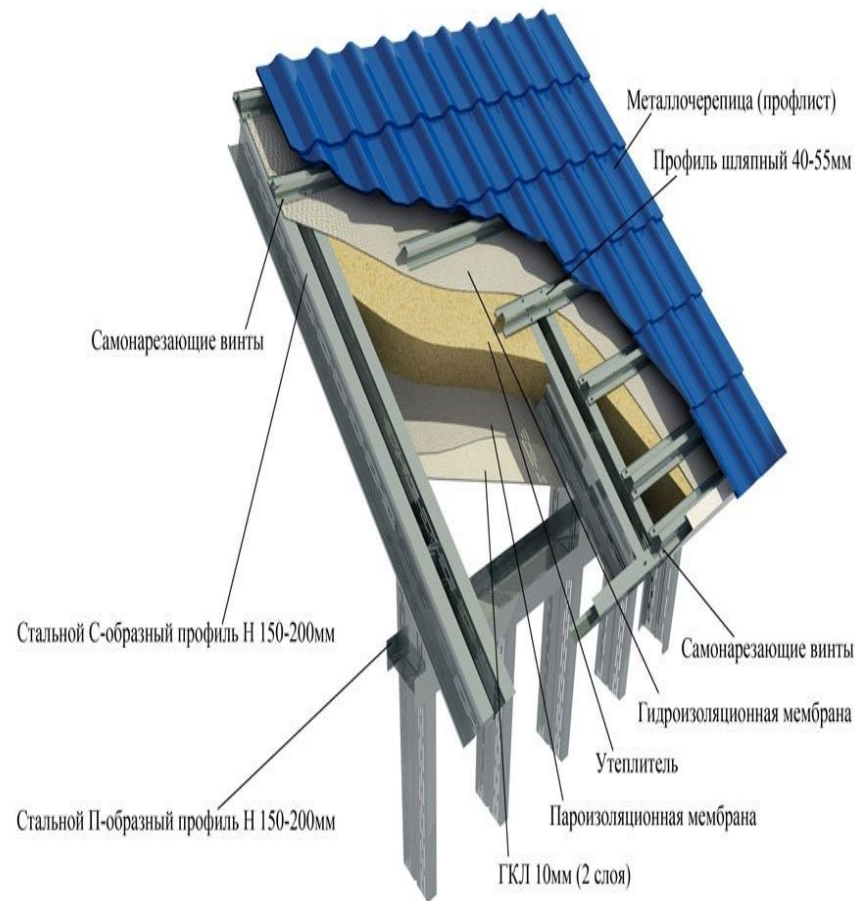
Пример устройства кровли
