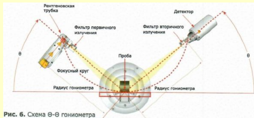
Рис. 6. Схема \theta - \theta гониометра
