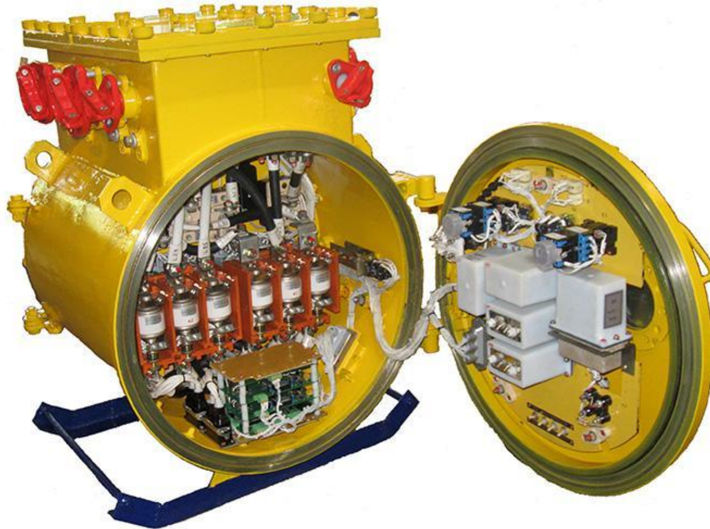
Устройство плавного пуска электродвигателя в исполнении РВ
