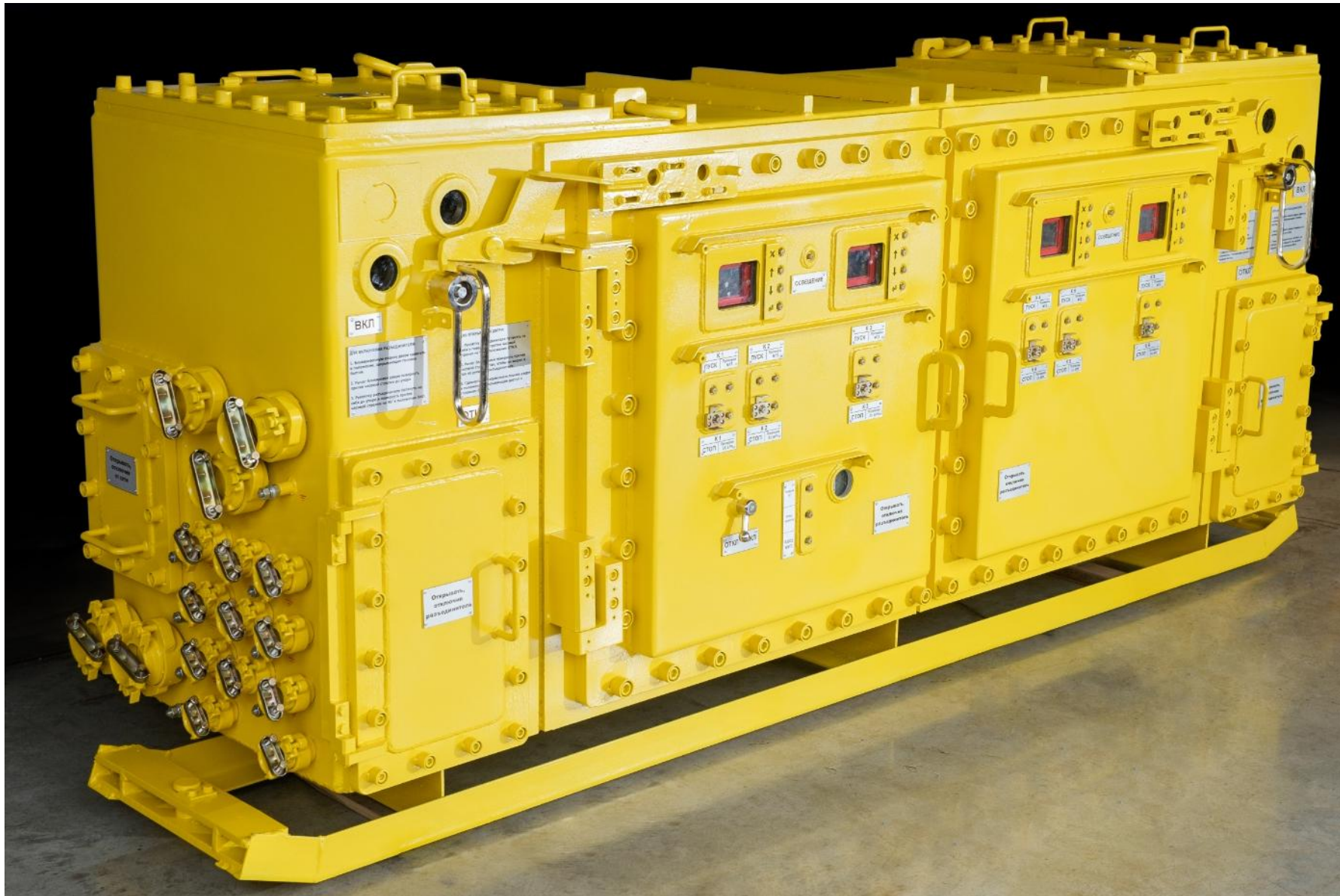
Станция управления добычный комбайном и самоходным вагоном
