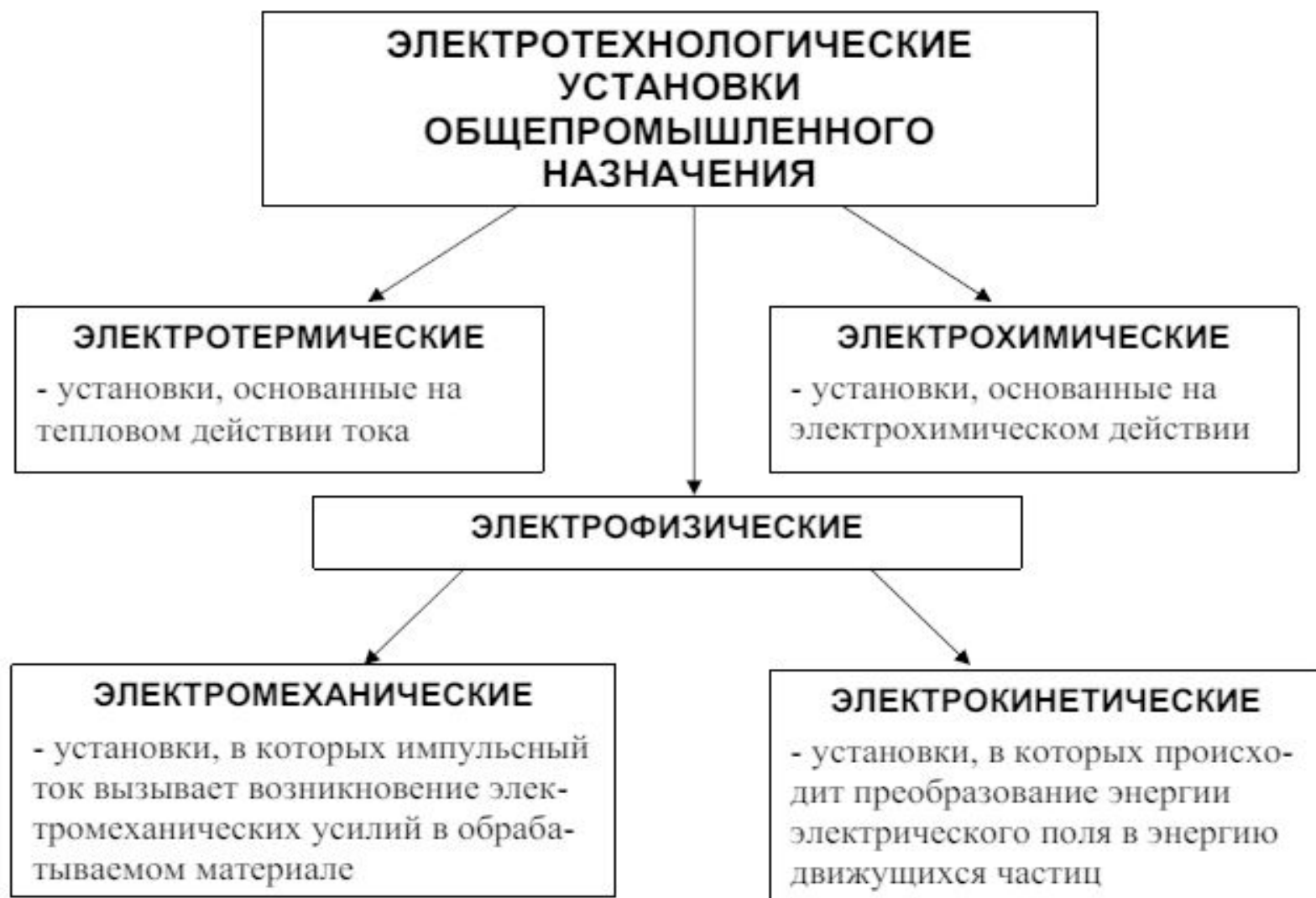
Рис. 1.2. Основные группы электротехнологических установок общепромышленного назначения
