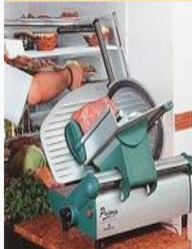
Рис. 5.23. Устройство слайсера для нарезки гастрономических товаров: 1 — станина; 2 — переключатель «пуск» / «стоп»; 3 — регулятор толщины нарезки; 4 — рабочая поверхность; 5 — направляющая пластина; 6 — прижимное устройство; 7 — защитный кожух; 8 — дисковый нож; 9 — регулятор рабочей каретки; 10 — затачивающее устройство; 11 — ножки
