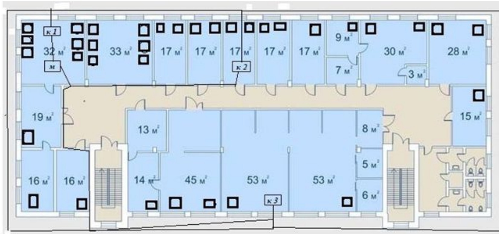
Физическая схема локальной сети
