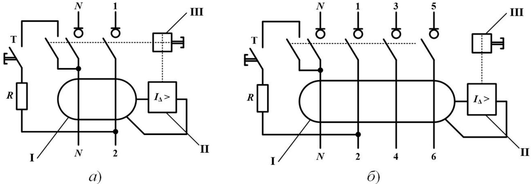
**Электрические схемы устройств защитного отключения:**
