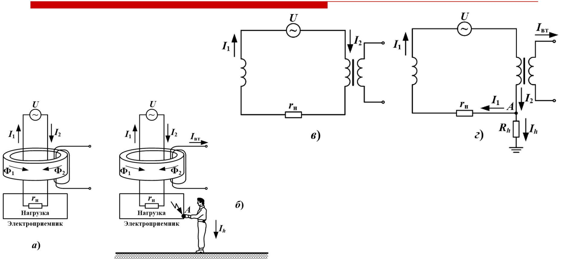
*а, в – в нормальном режиме; б, г – при повреждении изоляции*
