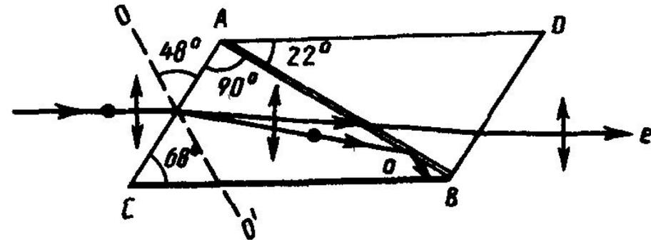
вдоль линии  $AB$  канадским бальзамом с  $n = 1,55$ . Оптическая ось  $OO'$  призмы составляет с входной гранью угол  $48^\circ$ . На передней грани призмы естественный луч, параллельный ребру  $CB$ , раздваивается на два луча: обыкновенный ( $n_o = 1,66$ ) и необыкновенный ( $n_e = 1,51$ ).
