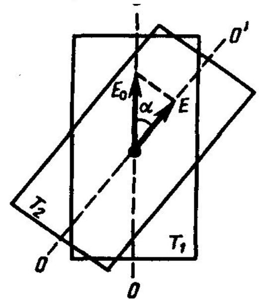
Пластинка  $T_1$ , преобразующая естественный свет в плоскополяризованный, является **поляризатором**, а  $T_2$ , служащая для анализа степени поляризации света, называется **анализатором**. Обе пластинки можно менять местами.
