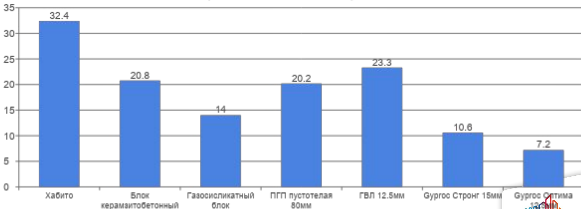
Твердость лицевой поверхности
