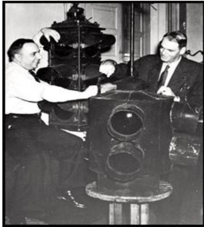
Первым прототипом был деревянный ящик со скатной крышей, в котором со всех четырех сторон горели красные и зеленые огни. Уайр окунул лампочки в красную и зеленую краску, чтобы получить цвета в соответствии с морским правом или использующиеся на железной дороге
