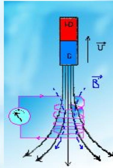
**1-м случае число линий магнитной индукции, пронизывающих витки катушки, увеличивается а во 2-м случае уменьшается. Причем в первом случае линии магнитной индукции возникающего в катушке магнитного поля индукционного тока выходят из верхнего конца катушки, а во втором случае наоборот входят в этот конец.**
