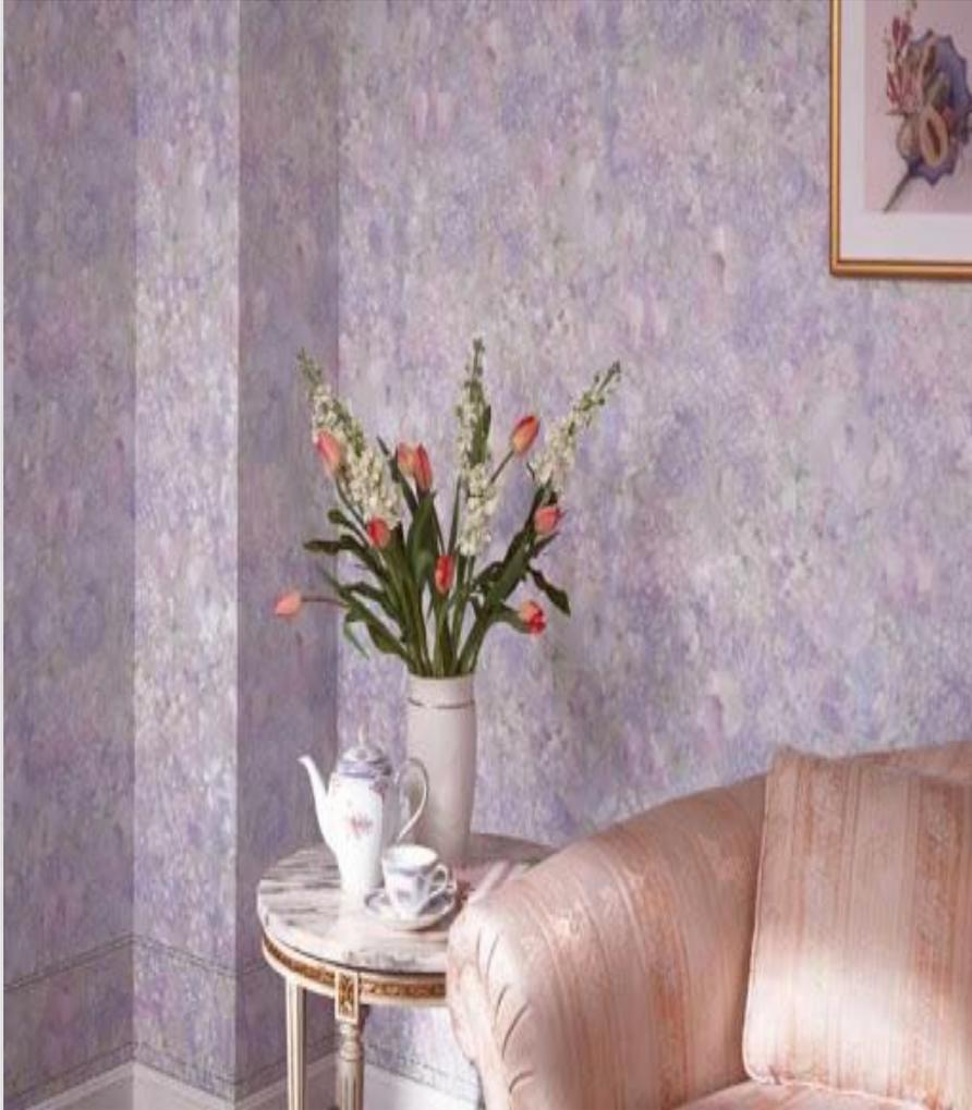
За странным словосочетанием скрывается материал, представляющий собой декоративную штукатурку, которая наносится на стену шпателем и затем выравнивается ровным слоем по поверхности стены. Такое покрытие скрывает неровности и маленькие трещины стен, но при этом позволяет стенам дышать, что препятствует появлению плесени.
