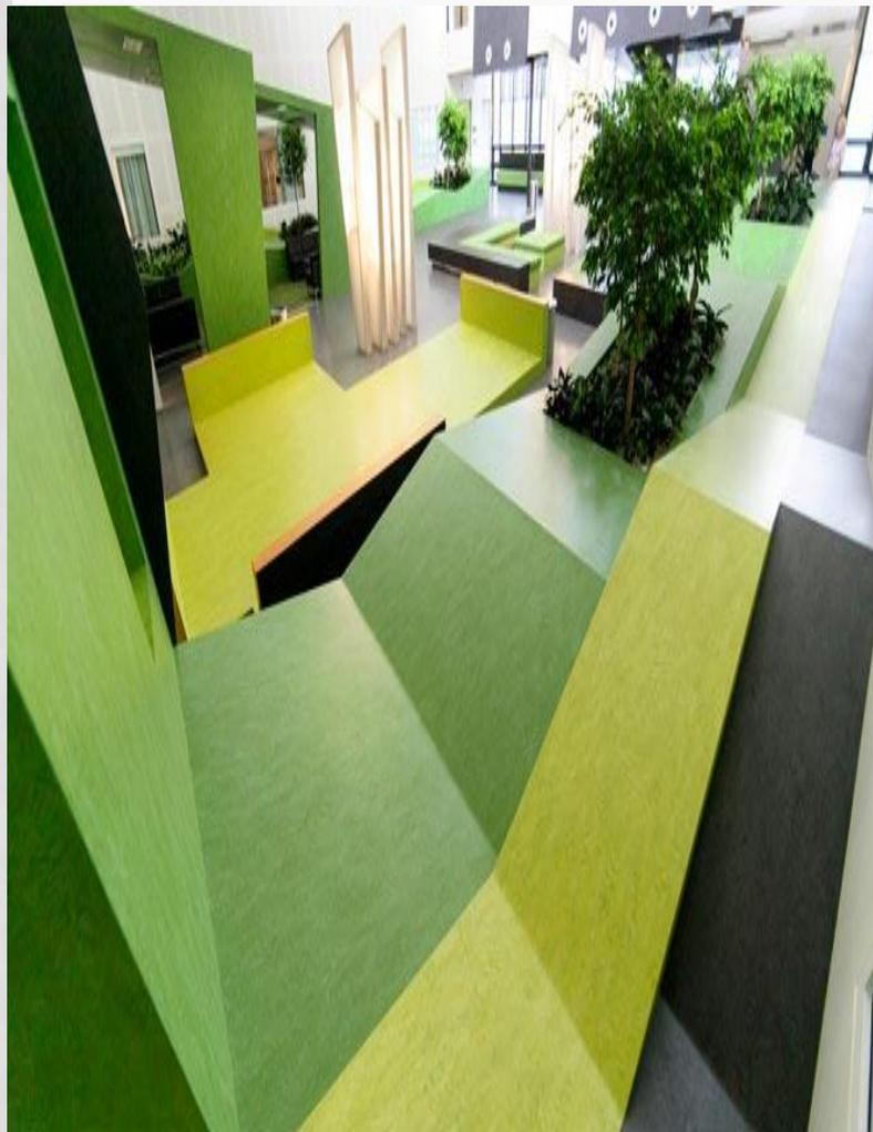
**Инновационный материал для напольного покрытия – усовершенствованный линолеум. Это экологическое покрытие, произведенное из натурального сырья. Мармолеум не коробится и не выцветает, имеет хорошие теплоизоляционные свойства, не токсичен, выдерживает большие нагрузки без потери эксплуатационных качеств.**
