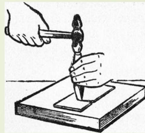
При **рубке на плите** зубило устанавливают на разметочную риску вертикально и наносят удары. После нанесения первого удара зубило устанавливают так, чтобы половина его режущей кромки находилась в уже прорубленной лунке, а половина – на разметочной риске, и наносят второй удар. При таком перемещении зубила по разметочной риске легче установить его в правильное положение и получить непрерывный надрез.
