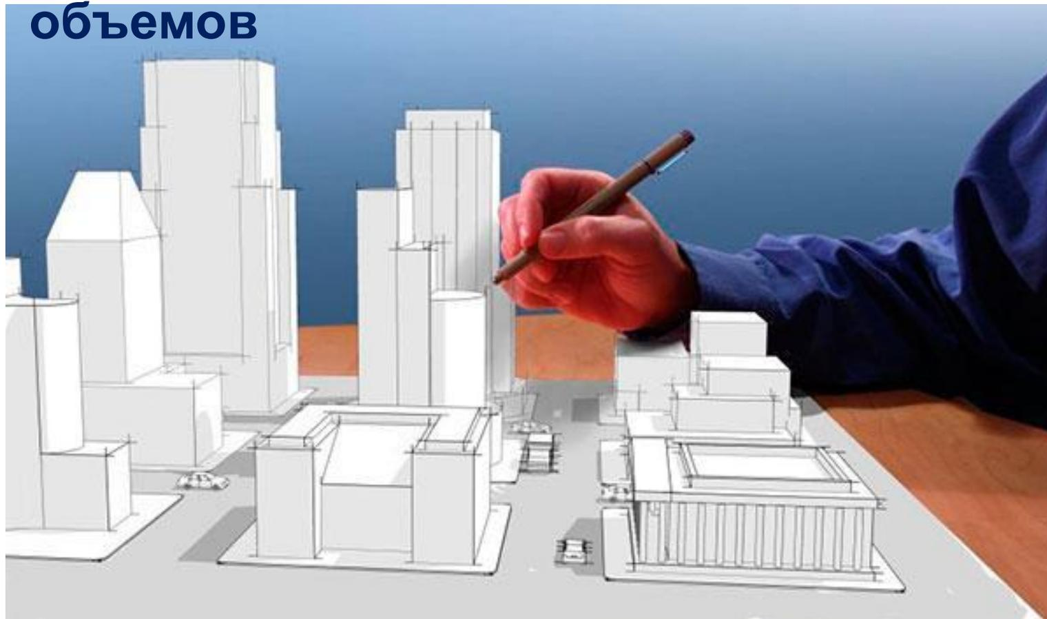
По виду композиции внешние объемы зданий могут быть простыми, состоящими из одного объема, и сложными — из двух и более объемов разной формы.
