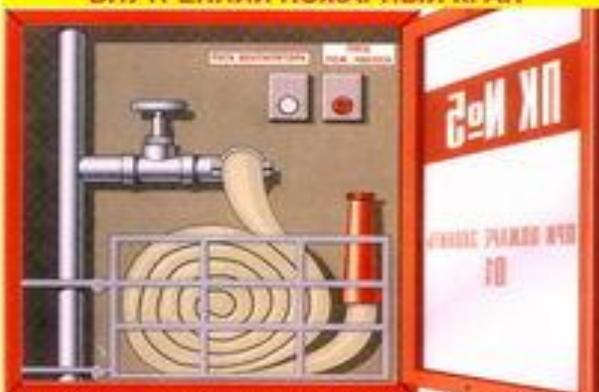
Предназначен для тушения пожаров водой от внутреннего водопровода жилых, административных и производственных помещений (кроме электроустановок под напряжением).
