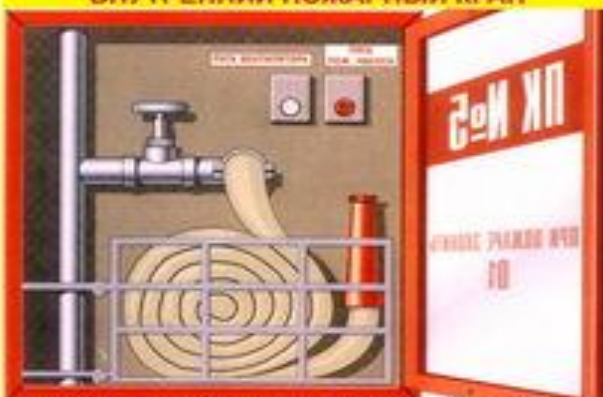
ВНУТРЕННИЙ ПОЖАРНЫЙ КРАН
