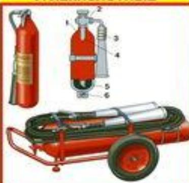
Применяется при загораниях на электроустановках под напряжением до 1000 В, двигателями внутреннего сгорания, ГЖ, при пожарах в музеях и архивах.
