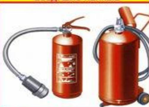
Применяется при загораниях различных веществ и материалов при температуре окружающей среды от +5 до +50 град., за исключением щелочных, щелочноземельных элементов и электроустановок под напряжением. Зимой хранить в отапливаемом помещении!
