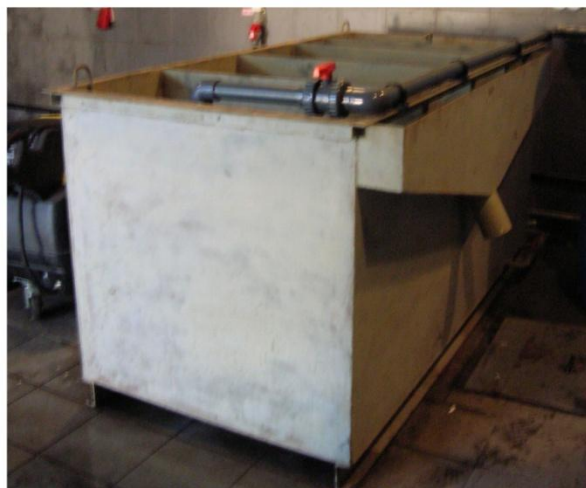
Опытно-промышленный образец комбинированной флотомашины пневматического типа с фильтрующими элементами внедренной в депо г. Смоленска.
