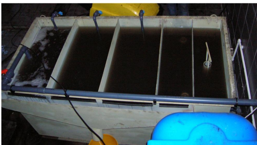
Опытно-промышленный образец комбинированной флотомашины пневматического типа с фильтрующими элементами внедренной в депо г. Смоленска.
