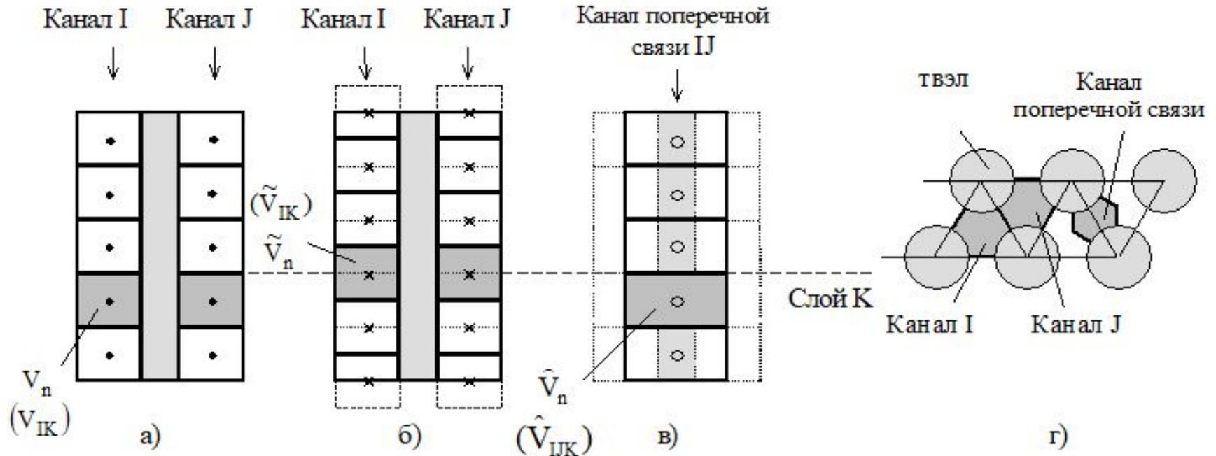
а) уравнений сохранения массы и энергии; б) уравнения сохранения продольной составляющей импульса; в) уравнения сохранения поперечной составляющей импульса; г) разбиение проходного сечения на каналы
