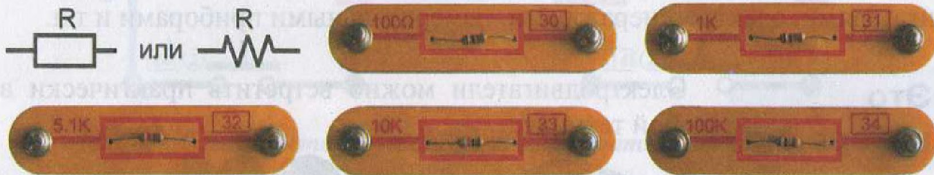
Рис. 5.1. Внешний вид и условные обозначения резисторов, встречающиеся в принципиальных схемах. Обозначение резистора в виде «пилы» часто встречается в компьютерных программах по моделированию схем
