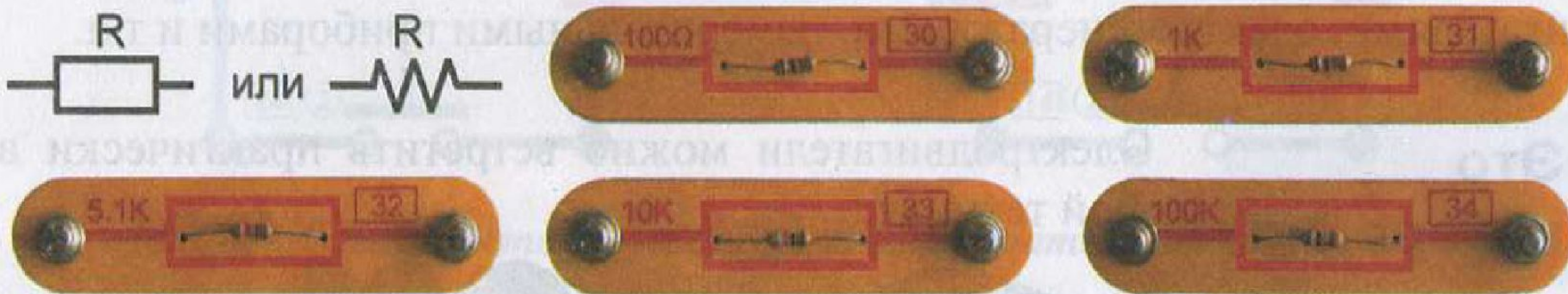
Рис. 5.1. Внешний вид и условные обозначения резисторов, встречающиеся в принципиальных схемах. Обозначение резистора в виде «пилы» часто встречается в компьютерных программах по моделированию схем
