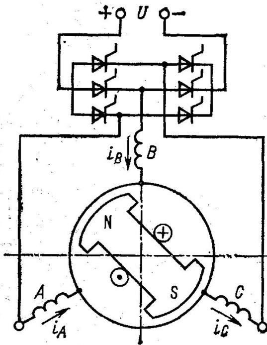
Система вентильной коммутации обычно состоит из датчика синхронизирующих сигналов, системы формирования сигналов управления и управляемого коммутатора.
