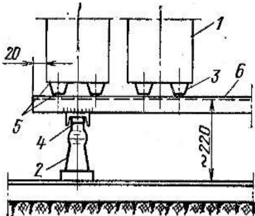
**Рис. 2. Установка АКБ на металлические стеллажи:**
