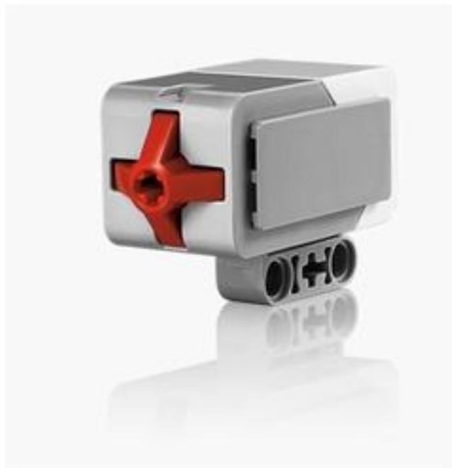
Датчик касания Lego EV3 является обычной пружиненной кнопкой. Очень похожая кнопка у обычных дверных звонков. Когда нажимаешь на кнопку раздается звонок. Если нажатия нет, то контакт под действием пружины возвращается обратно.
