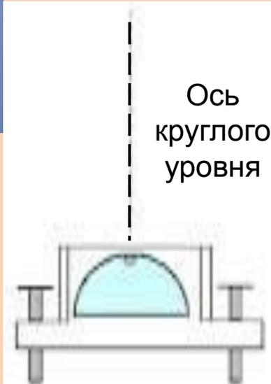
**1.** Зрительную трубу устанавливают параллельно двум подъемным винтам. Тремя подъемными винтами приводят пузырек круглого уровня в нуль-пункт.
