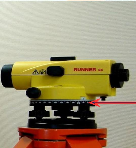
Если нивелир оборудован **лимбом** (горизонтальным **крутом с делениями**), то таким прибором можно измерять и строить **горизонтальные углы**.
