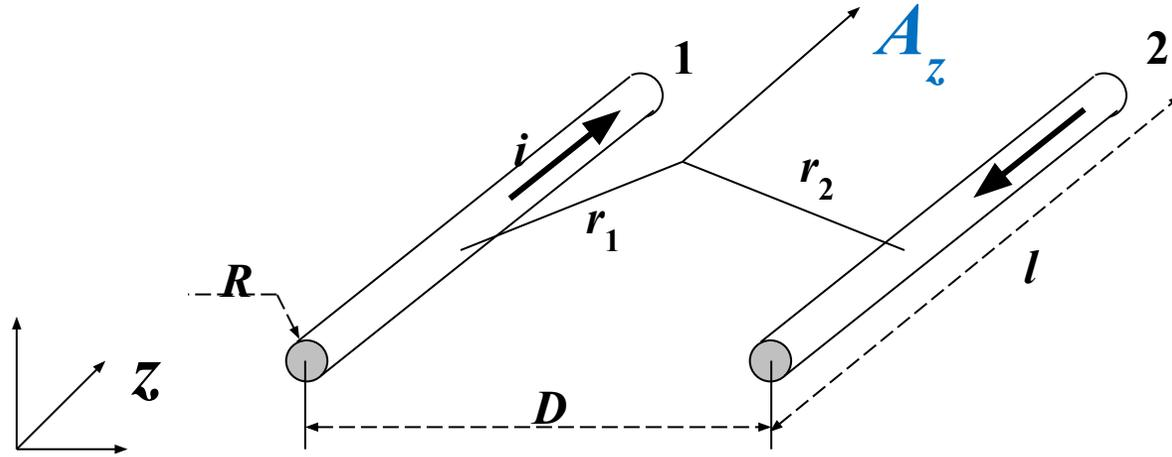
В произвольной точке около двухпроводной линии векторный магнитный потенциал равен  $A_z = \frac{\mu_0 i}{2\pi} \ln \frac{r_2}{r_1}$
