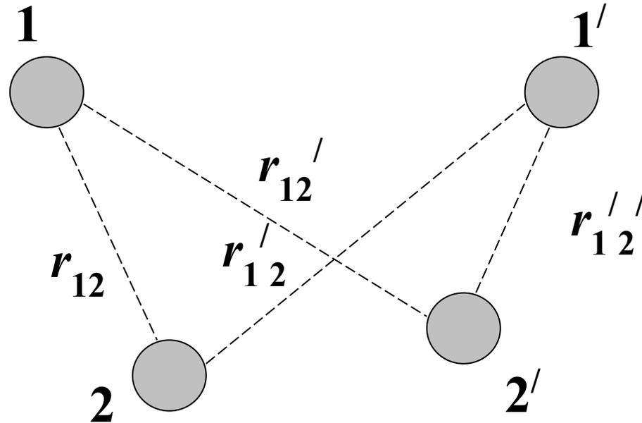
Зададимся током в первой линии и определим векторный магнитный потенциал на осях проводов второй линии:
