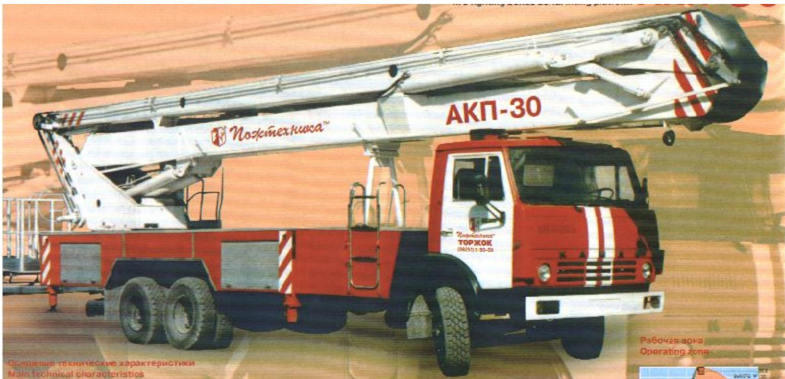
Шасси КамАЗ, MAN, Scania, Renault (6 x 4), (6 x 6)
