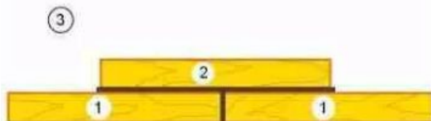
Склеивание с применением накладки.
