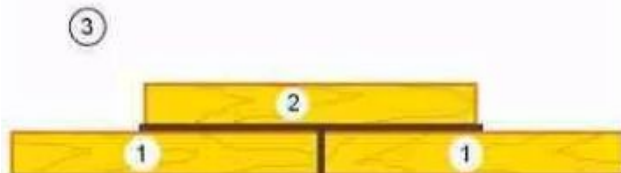
Склеивание с применением накладки.
