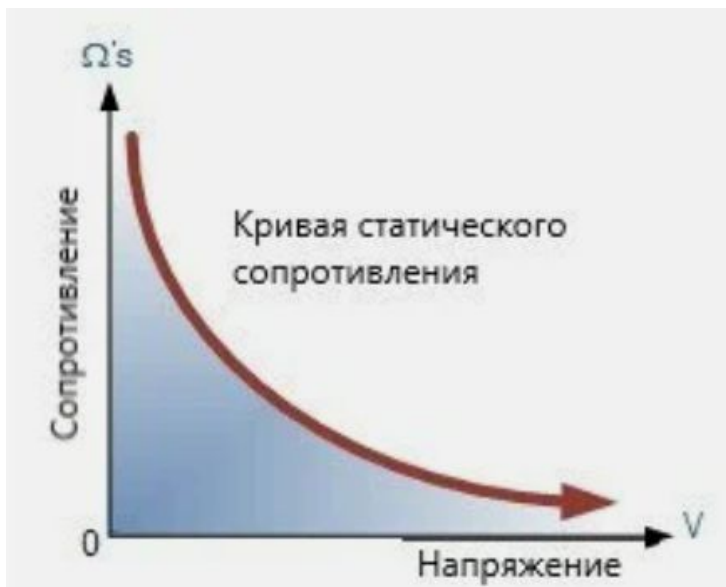
Рисунок 14 – Зависимость сопротивления Варистора от напряжения.
