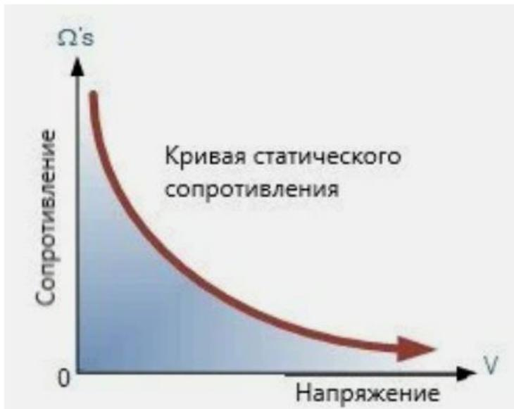
Рисунок 14 – Зависимость сопротивления Варистора от напряжения.
