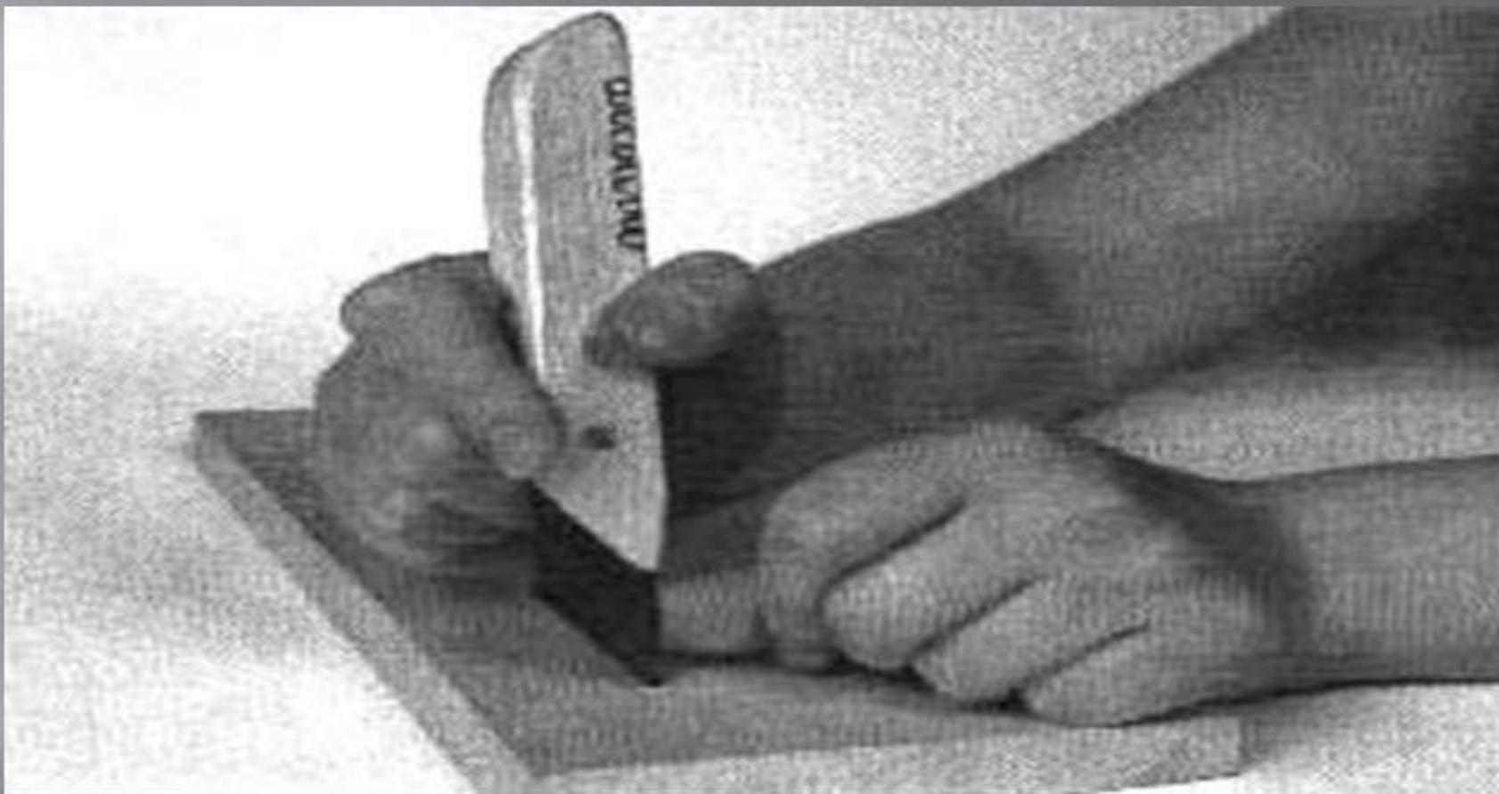
■ Рис. 9. Захват ножа-косяка при резьбе от себя
