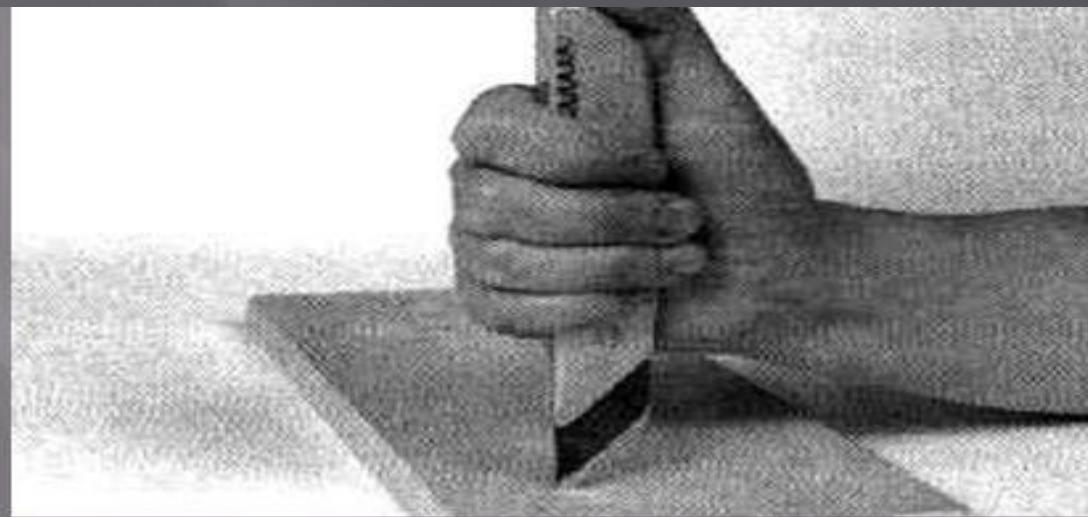
■ Рис. 7. Захват ножа-косяка при резьбе на себя 1 способ
