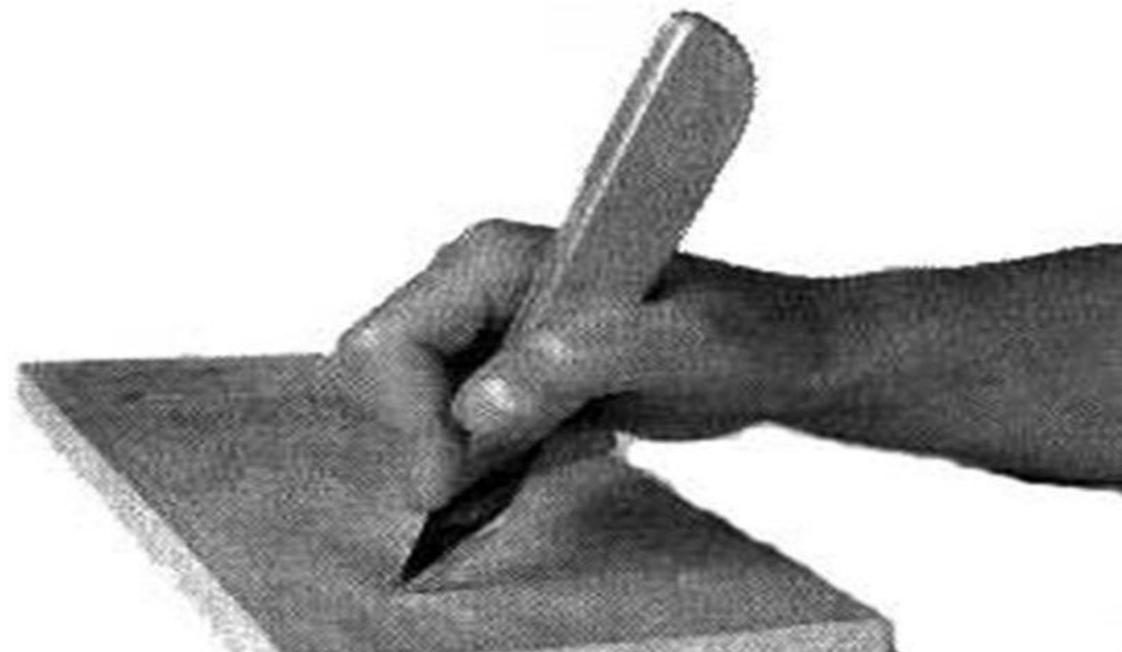
■ Рис. 8. Захват ножа-косяка при резьбе на себя 2 способ
