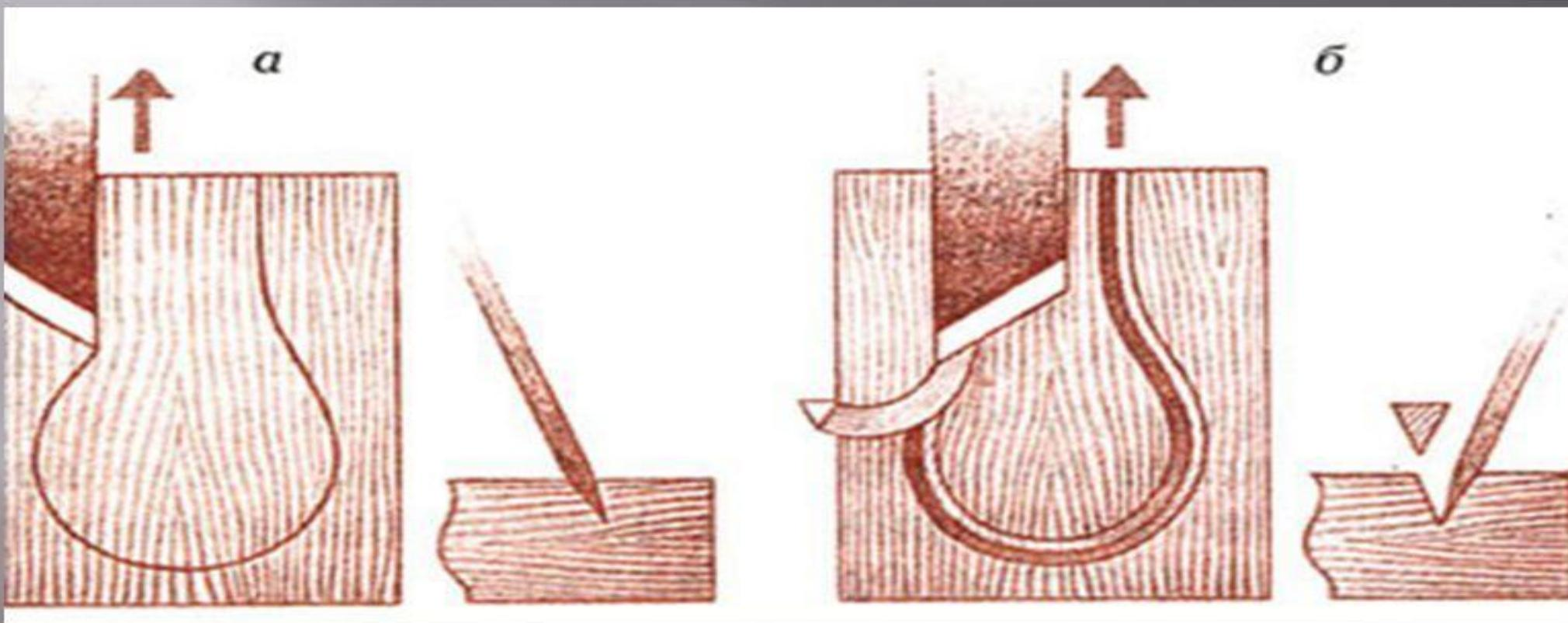
■ Рис. 1. Последовательность выполнение контурной резьбы: а- надрезка; в - подрезка
