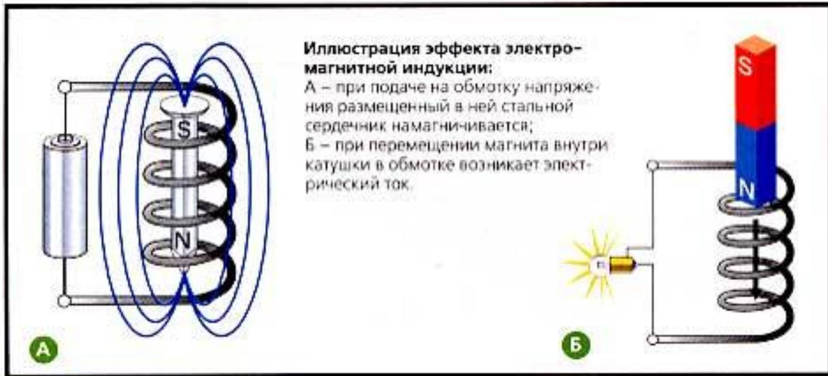
**Явление ЭМИ заключается в возникновении индукционного тока в замкнутом проводнике при всяком изменении магнитного потока, пронизывающего контур замкнутого проводника. Существование тока наблюдается в течении всего процесса изменения магнитного потока.**
