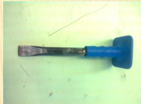
*Крейцмейсель* — это узкое зубило, предназначенное для вырубания узких канавок, пазов и т. д.
